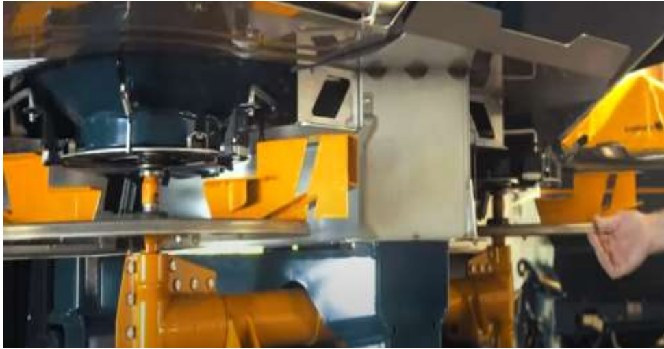
Slika 19. Diskovi na Bogballe rasipaču (YouTube, 2019.)
