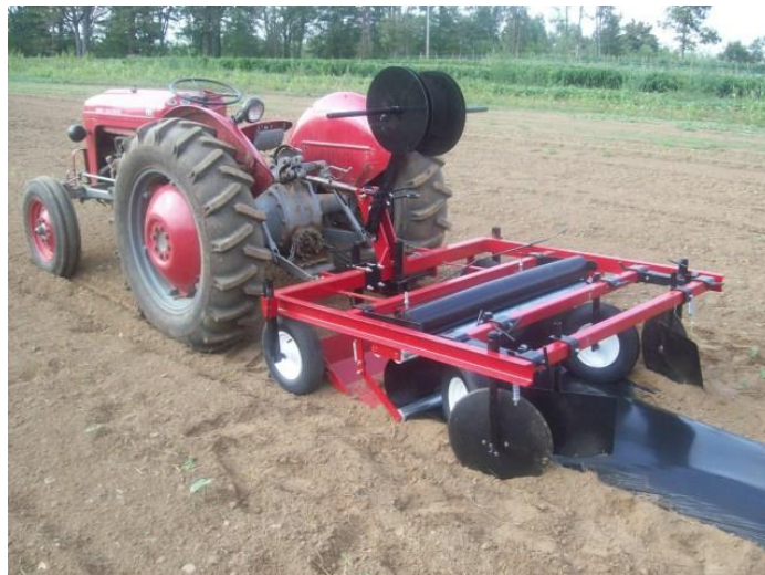
Slika 3. Postavljanje PE folije
