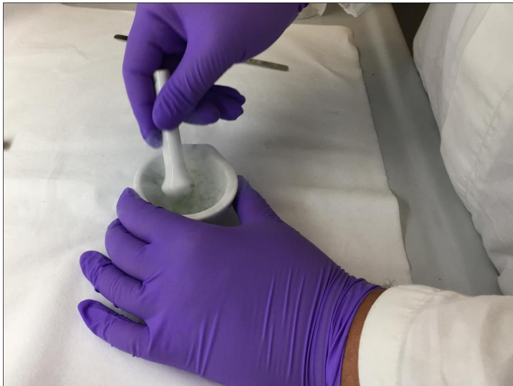
Slika 4. Homogenizacija tkiva pomoću tekućeg dušika (Dobiš, L.)
