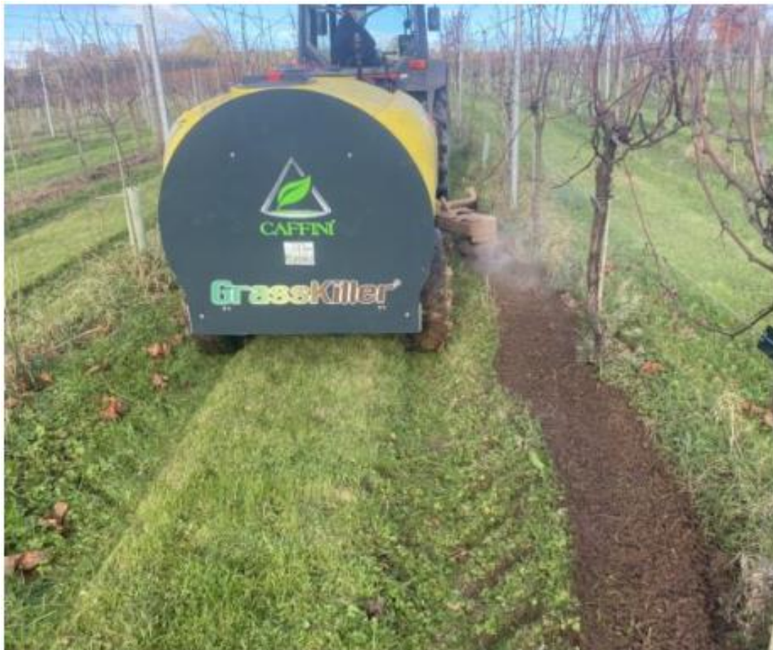
Slika 11. Ekološka kontrola korova zagrijanom pjenom (Izvor: https://www.caffini.com/en/grasskiller/121-grasskiller.html )
