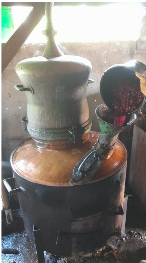
Slika 14. Dodavanje fermentirane smjese u kazan (vlastiti izvor)
