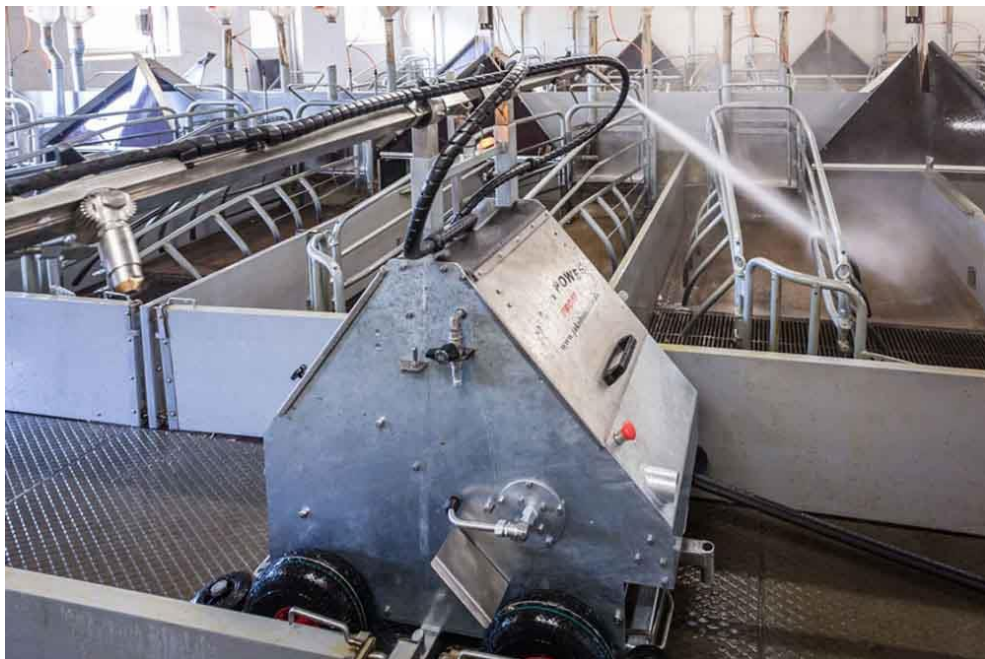
Slika 6. Robot za pranje boksova
