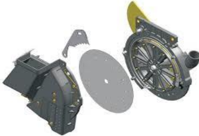
Slika 9. Sjetveni aparat kod sijačice MaterMacc Twin Row
