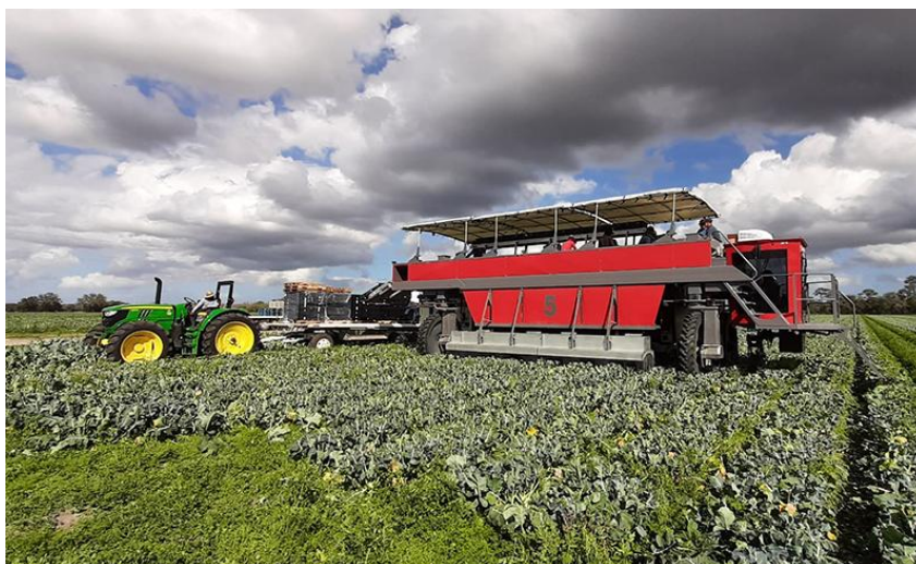
Slika 6. Računalno upravljani kombajn za brokulu
