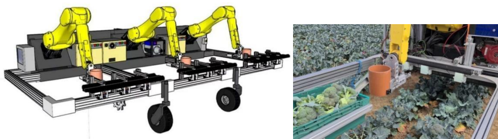
Slika 7. Senzori detektiraju položaj biljke brokule, nakon čega uređaj za rezanje na ruci robota odsiječe povrće
