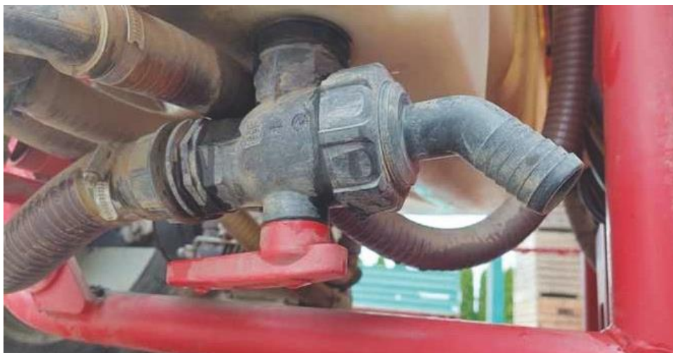
Slika 10. Otvor za pražnjenje tehničkog ostatka spremnika sa slavinom
