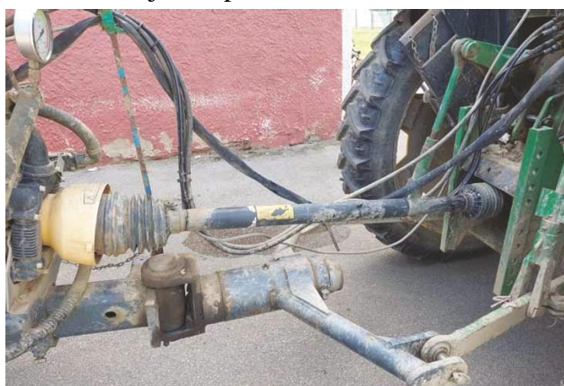
Slika 5. Kardansko vratilo traktora u zaštitnoj plastici
