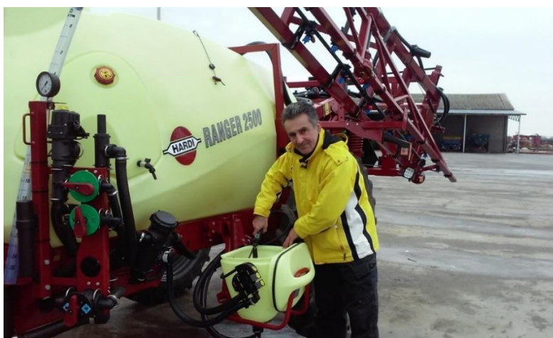
Slika 9. Uređaj za punjenje sredstvom za zaštitu bilja
