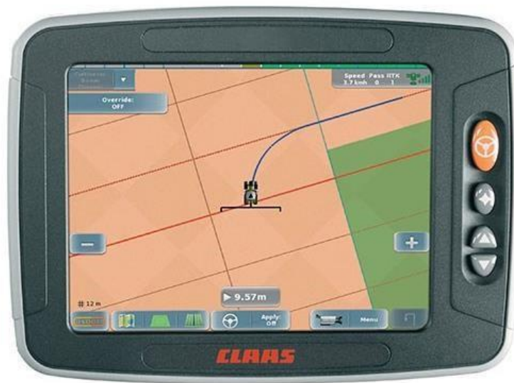
Slika 20. CLAAS TURN IN proširenje sustava navođenja
