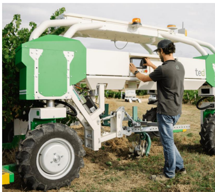
Slika 13. Kalibracija radnog organa kod robota Ted
