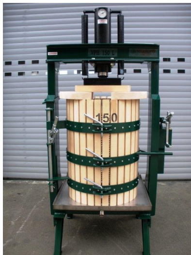
Slika 2. Hidraulična preša za grožđe
