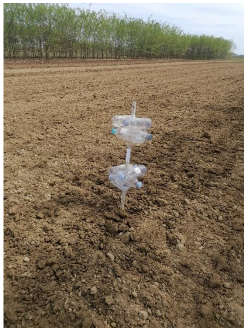
Slika 3 – Mjerna stanica za skupljanje lebdećih čestica
