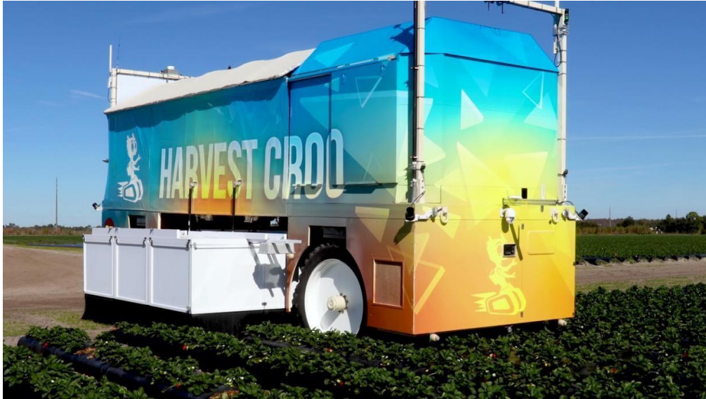
Slika 10. Harvest CROO Robotics berač jagoda (Izvor: Harvest CROO Robotics, 2024.)
