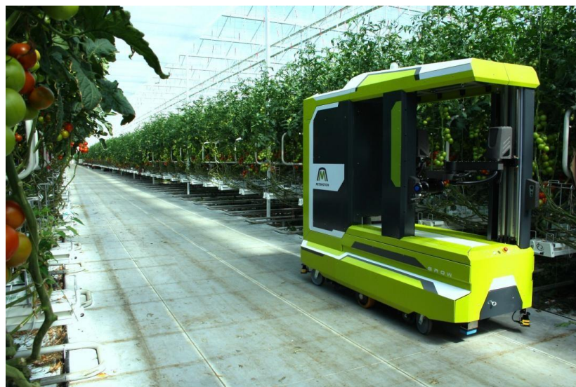
Slika 15. MetoMotion robot za ubiranje rajčica (Izvor: The Times Of Israel, 2023.)
