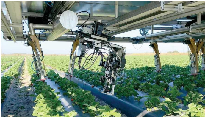
Slika 11. Pojedinačni roboti Harvesta CROO berača jagoda (Izvor: Growing produce, 2018.)
