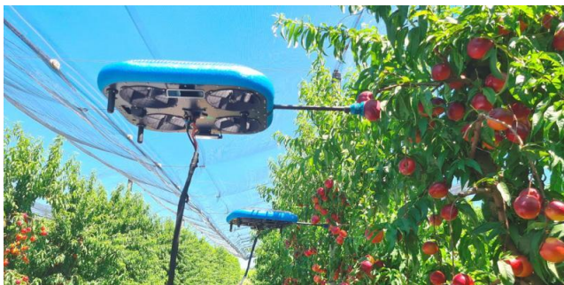
Slika 29. Bespilotna letjelica s ugrađenim radnim elementom Tevel Robota
