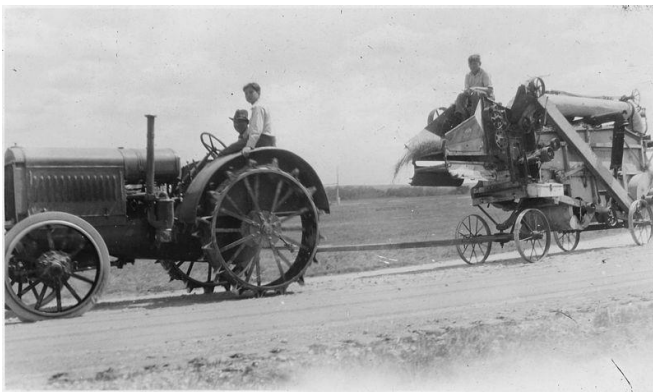
Slika 3. International Harvesterov prvi kombajn vučen traktorom, 1915. (Izvor: Plant Planet, 2021.)
