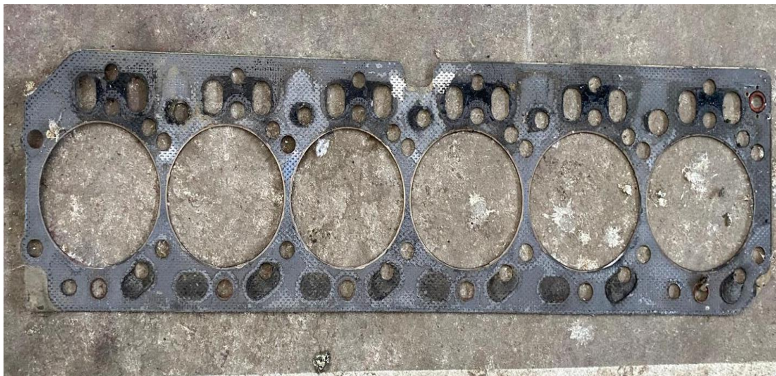
Slika 13. Neispravna brtva glave motora
