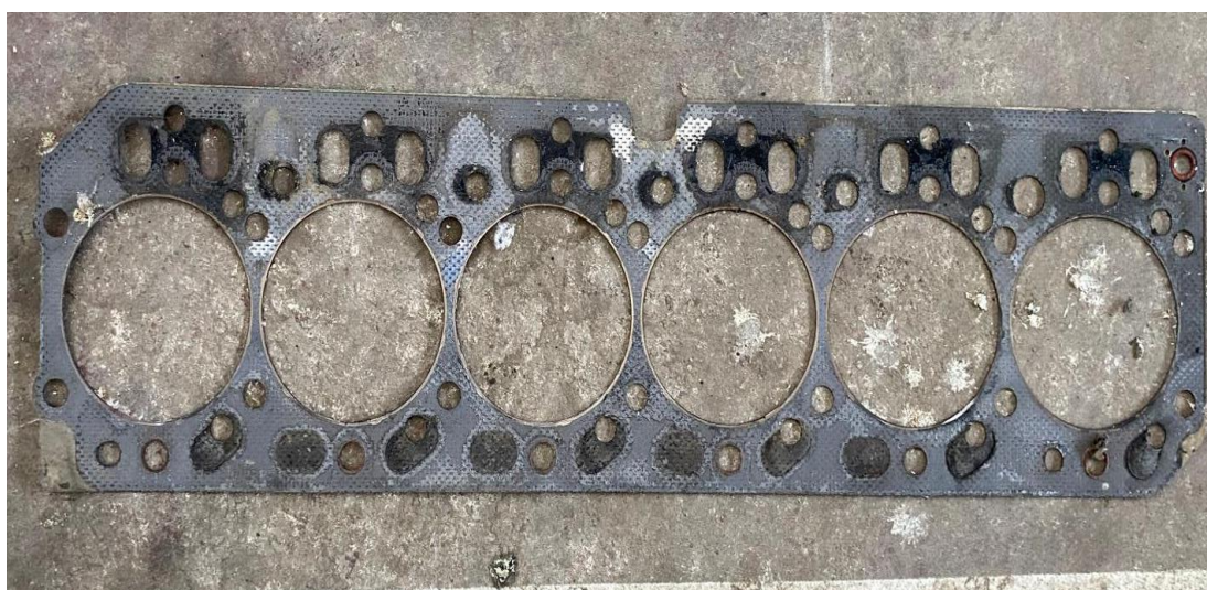
Slika 13. Neispravna brtva glave motora
