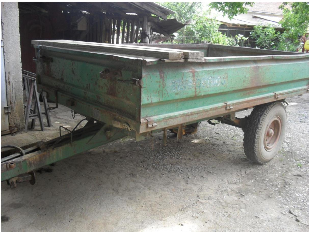
Slika 16. Prikolica „Tehnostroj“, nosivost 3 t (Izvor: Vlastita fotografija)
