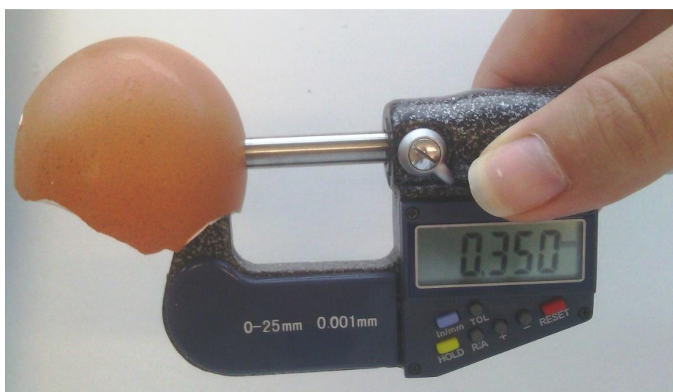
Slika 14. Mjerenje debljine ljuske pomoću elektroničkog mikrometra
