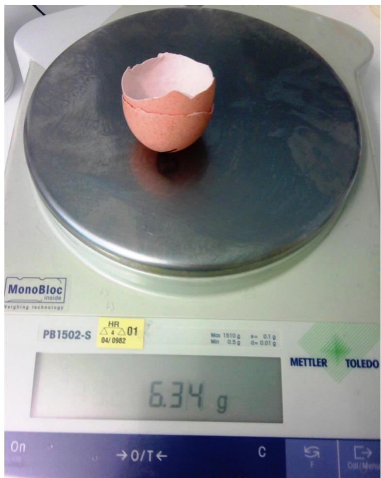
Slika 8. Vaga za mjerjenje mase jaja i osnovnih dijelova Mettler Toledo PB 1502 – S;
