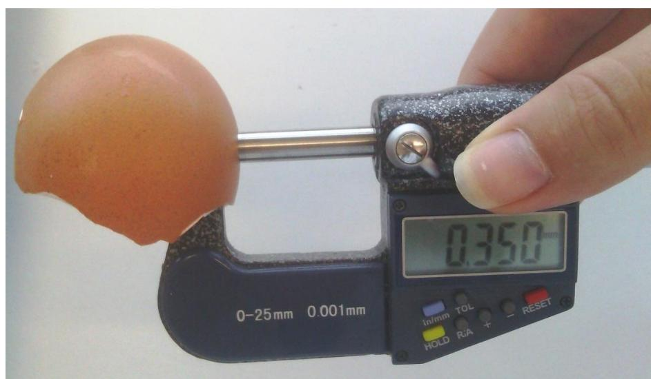
Slika 14. Mjerjenje debljine ljske pomoću elektroničkog mikrometra
