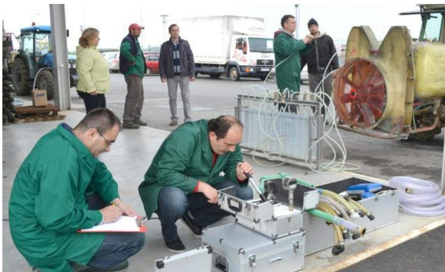
Slika 12. Ispitivanje raspršivača
