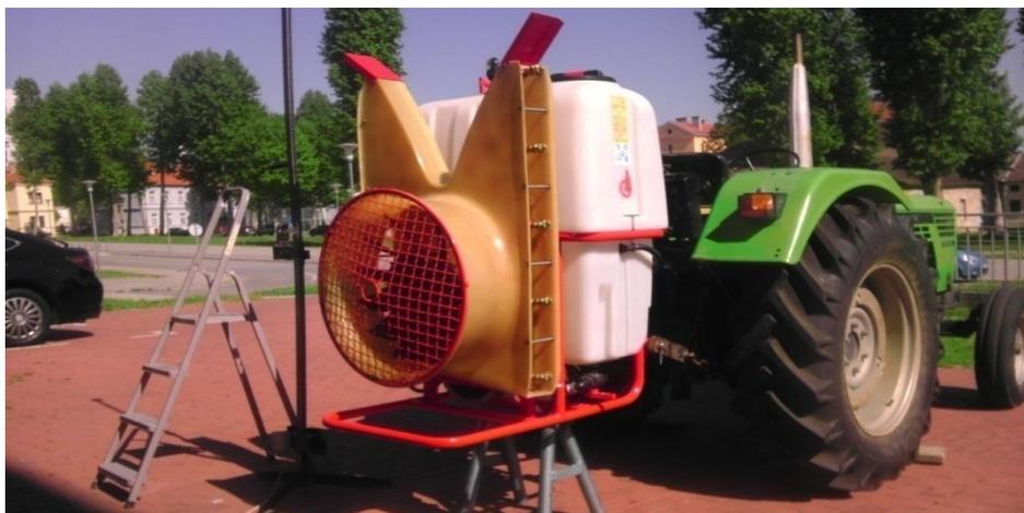
Slika1. Traktorski nošeni raspršivač tvrtke Agromehanika
