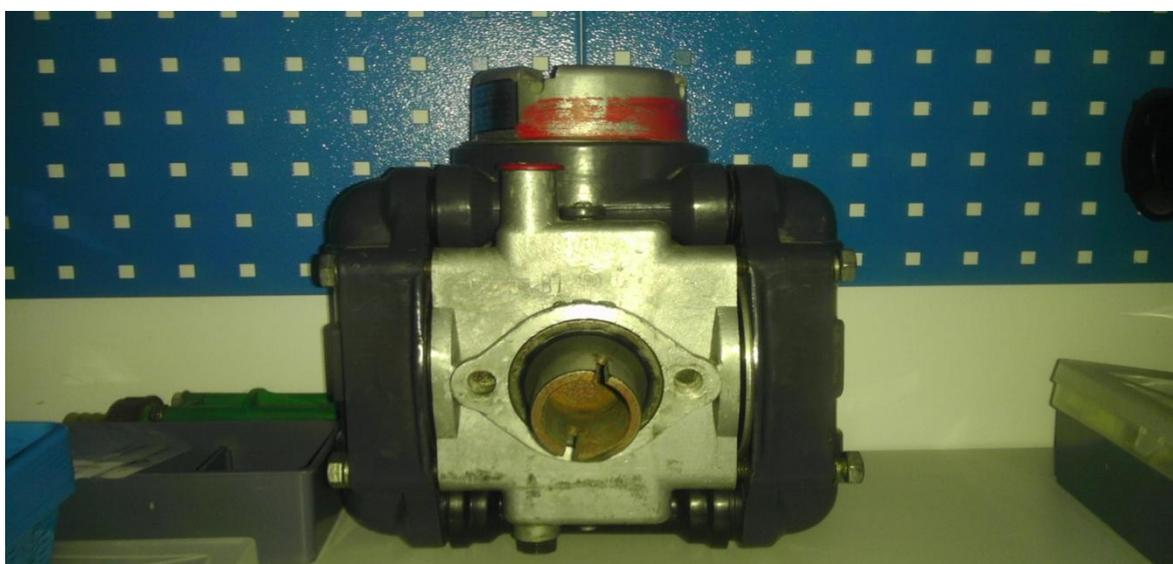
Slika 5. Crpka raspršivača
