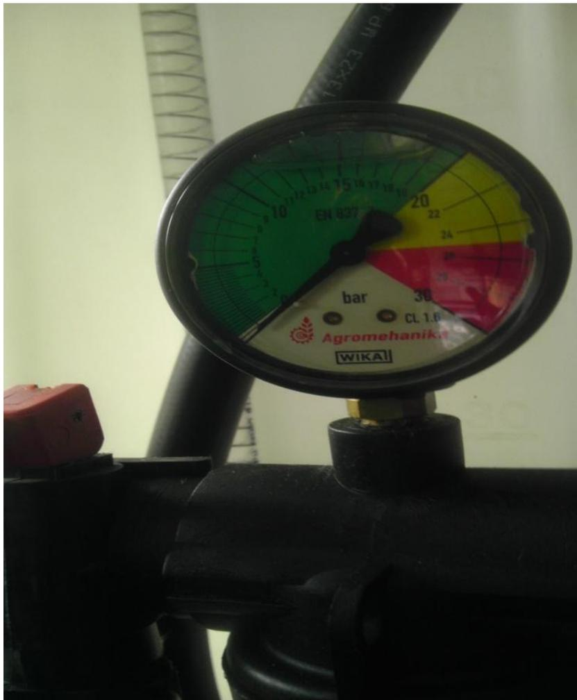
Slika 10. Manometar na raspršivaču Agromehanika 400 EN
