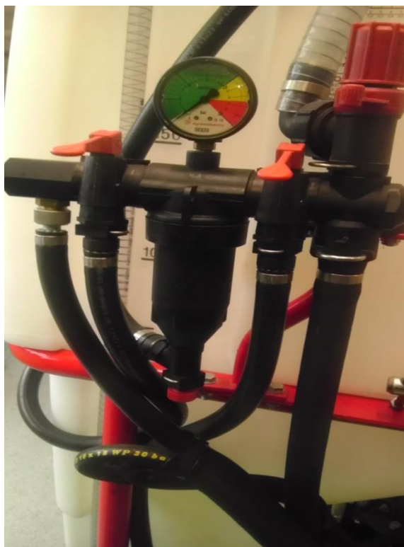
Slika 9. Regulator raspršivača Agromehnika 400
