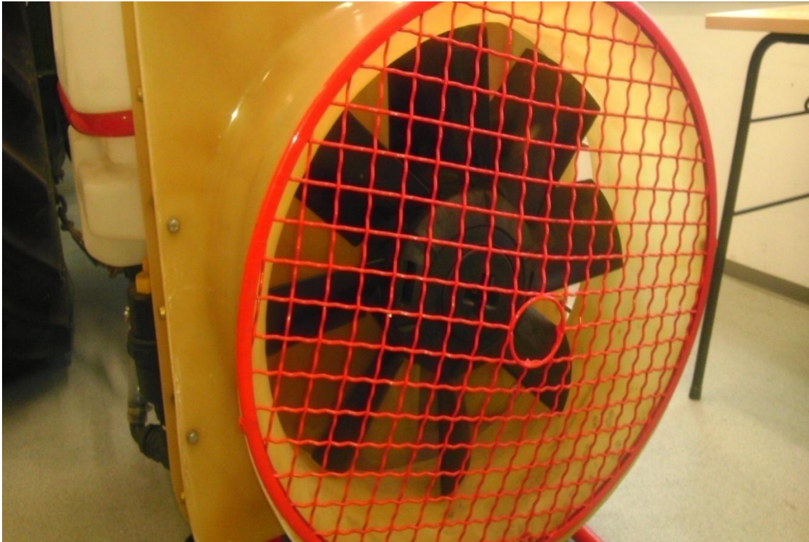
Slika 2. Aksijalni ventilator raspršivača Agromehanika
