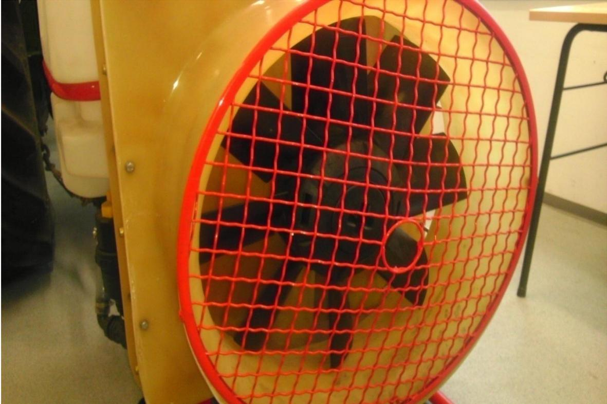
Slika 2. Aksijalni ventilator raspršivača Agromehanika
