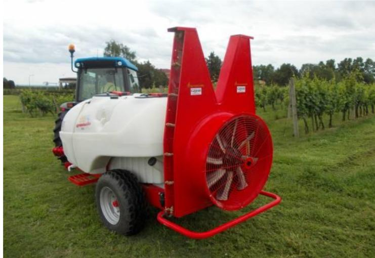
Slika 3. Vučeni raspršivač tvrtke Agromehnika
