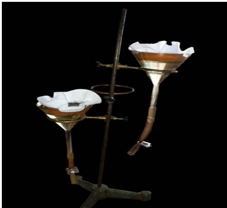
Slika 4. – Baermanova metoda ekstrakcije nematoda
