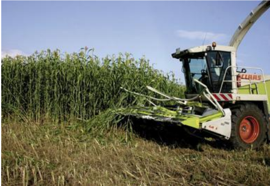
Slika. 14. Žetva silažnoga sirka silažnim kombajnom.
