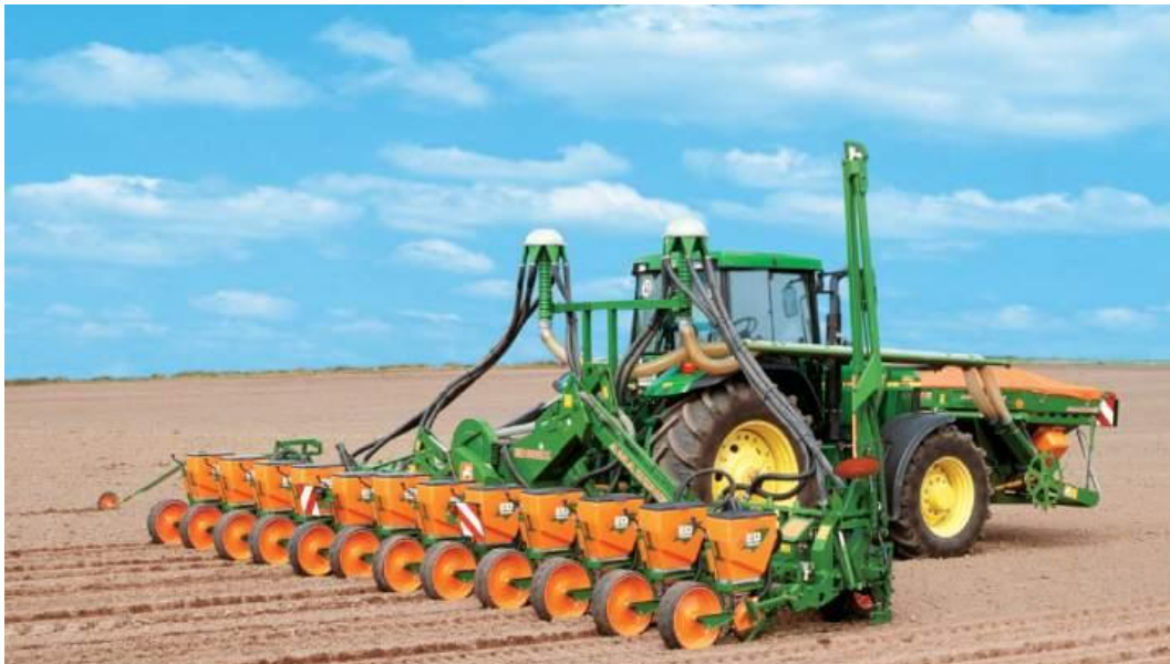
Slika 2. Sjetva sirka pneumatska sijačicom za kukuruz ili šećernu repu.
