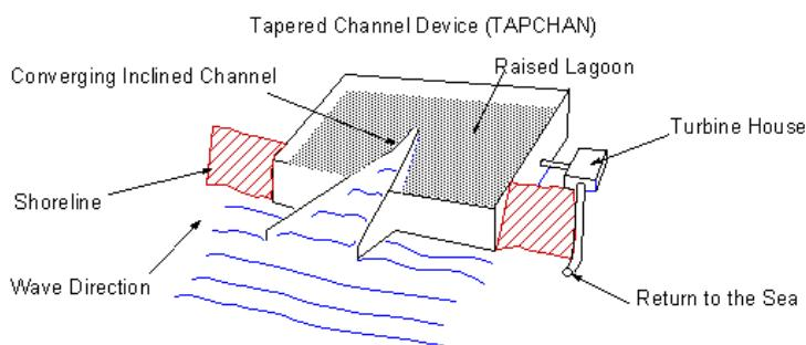
*Slika 15. : Ilustracija rada HE na valove(s oscilirajućim stupcem vode i s akumulacijskim bazenom)*
