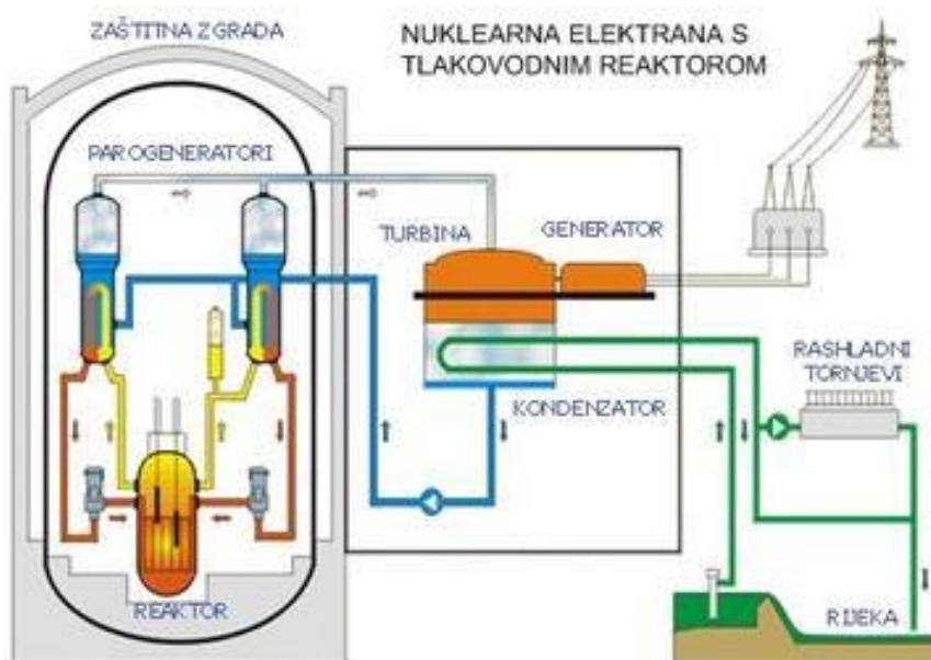
Slika 2. : Diagram rada NE s tlakovodnim reaktorom (PWR).
