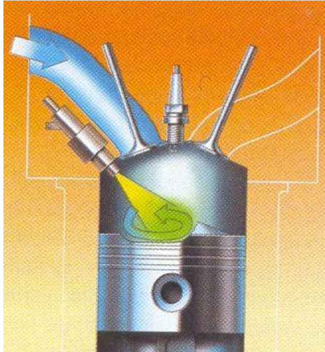
Slika 6. „M“-postupak direktnog ubrizgavanja goriva
