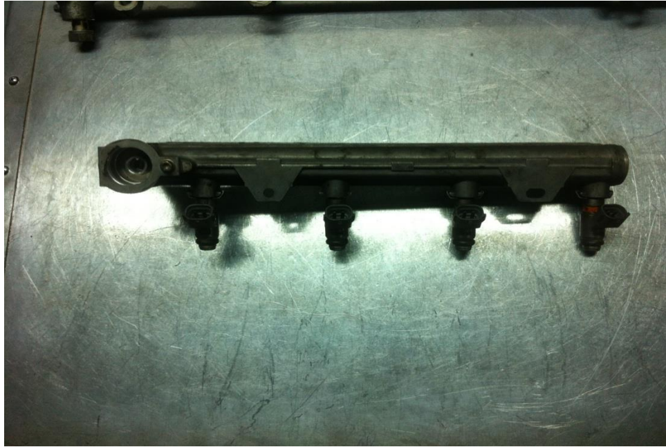
Slika 15. Visokotlačna cijev (Izvor: vlastita fotografija)
