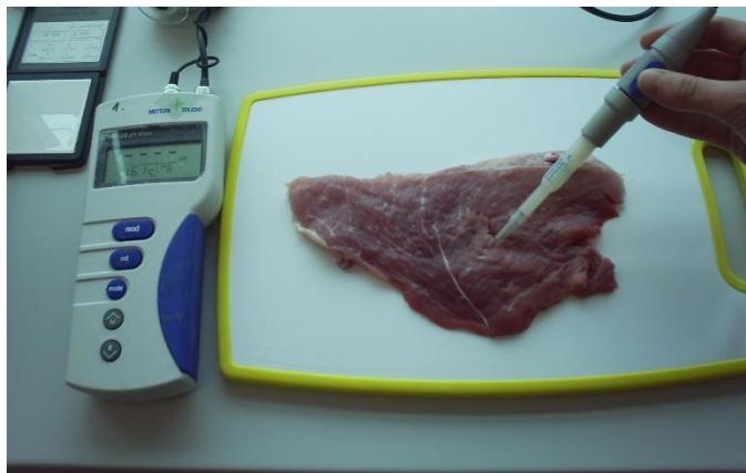
Slika 3. Mjerenje pH na *m.semimembranosus*
