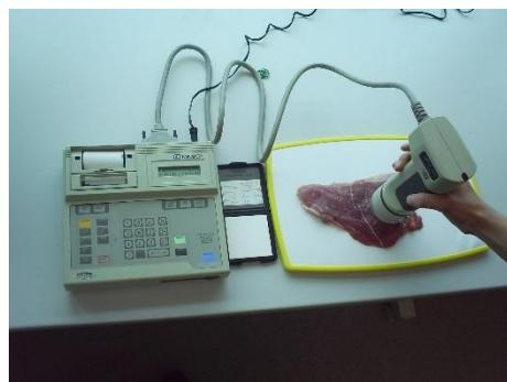
Slika 6. Mjerenje boje na *m.semimembranosus*
