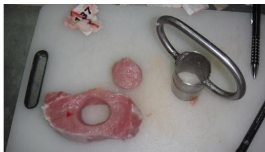
Slika 4. Prikaz mjerenja otpuštanja mesnog soka “metodom vrećice”
