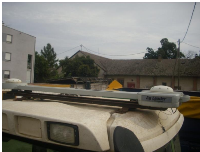
Slika 20. ParaDyme dvojna antena
