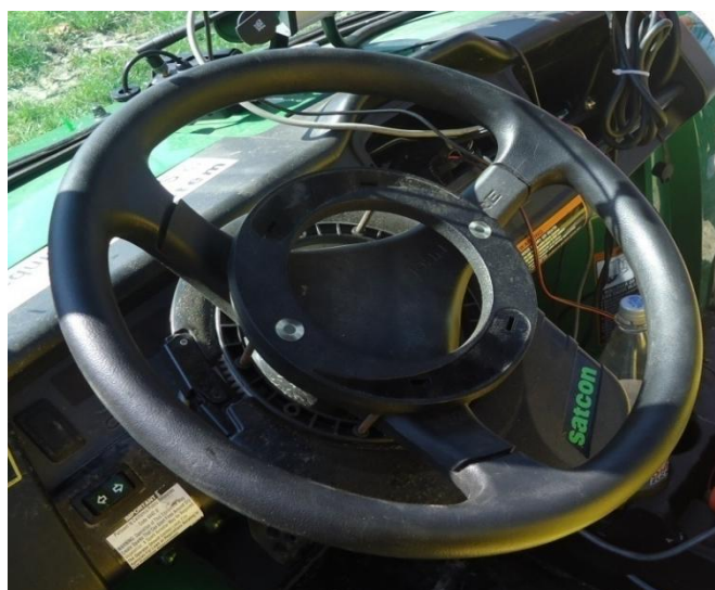
Slika 14. Sustav za automatsko upravljanje (Auto-steering)
