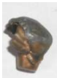
Slika 52. Hornady zrno nakon prolaska kroz trup divljači (foto: D. Podlesak)
