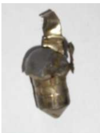
Slika 56. „Tumbano“ TUG zrno nakon odstrjela (foto: D. Podlesak)
