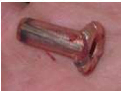
Slika 74. Grom zrno nakon odstrjela divljači (foto: D. Podlesak)
