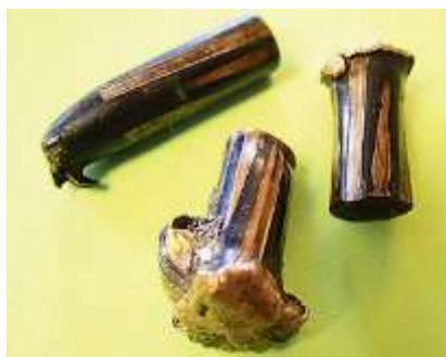
Slika 71. Nosler Black Talon zrno nakon odstrjela divljači (foto: D. Podlesak)
