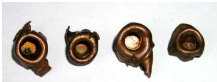
Slika 49. Ostaci košuljice zrna (foto: D. Podlesak)
