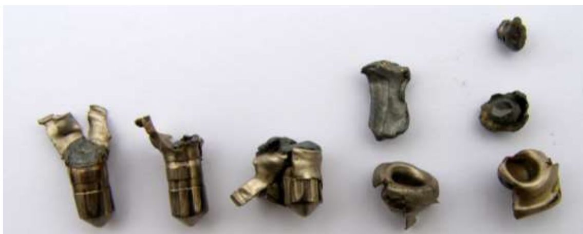
Slika 58. Ostaci Breneke TUG zrna nakon odstrjela divljači – tumbanje (foto: D. Podlesak)
