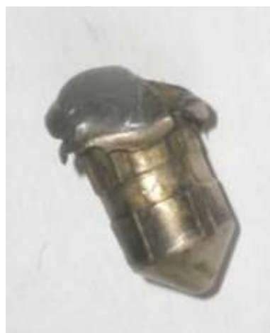
Slika 57. Izgled TUG zrna nakon odstrjela divljači (foto: D. Podlesak.)
