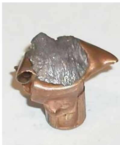
Slika 55. Zrno Swift A- Frame nakon odstrijela divljači (foto: D. Podlesak)
