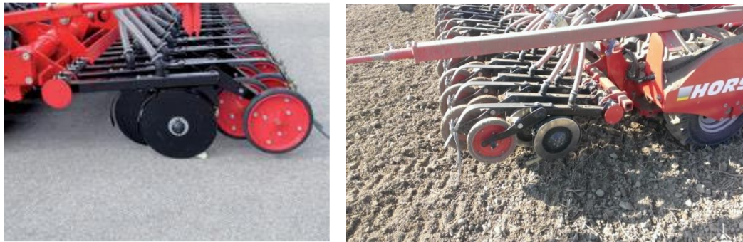
Slika 20. Sklop raonika za sijanje
