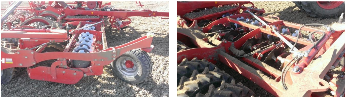
Slika 18. Sistem diskova koji vrši usitnjavanje
