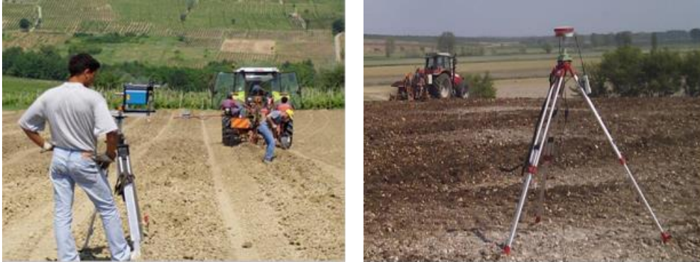
Slika 40. Sustav za održavanje pravca
