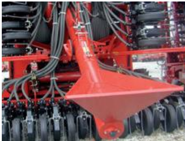
Slika 22. Pužnica za punjenje spremnika
