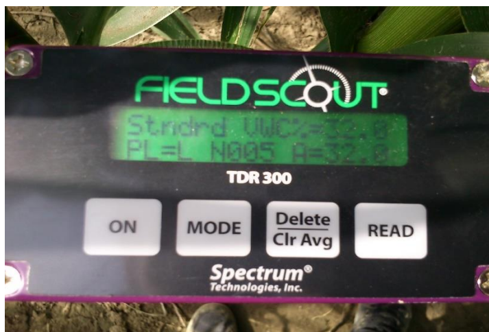
Slika 2. Sučelje TDR uređaja (Izvor: J. Huđek)
