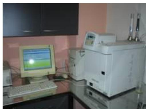
Slika 10. Analizator bioplina plinski kromatograf Varian 3900
