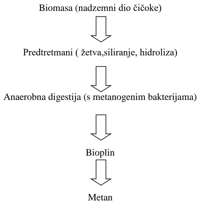
Slika 9. Faze proizvodnje bioplina iz nadzemne mase čičoke
