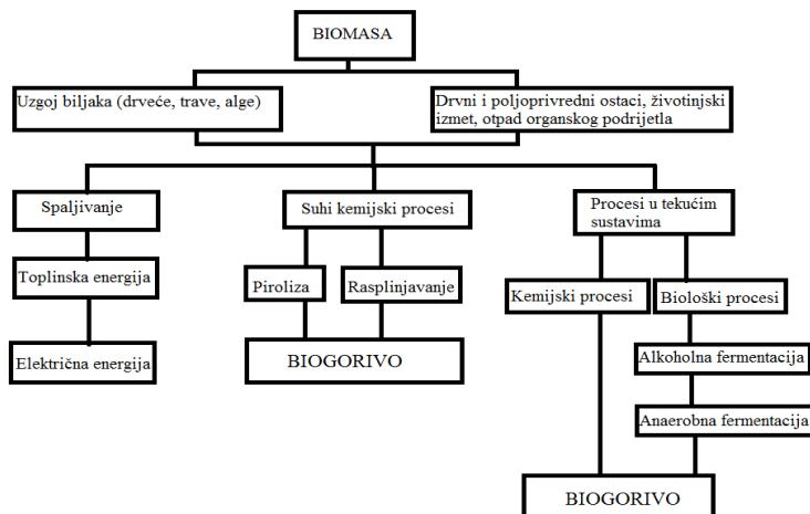
Slika 8. Načelna shema proizvodnje energije iz biomase
