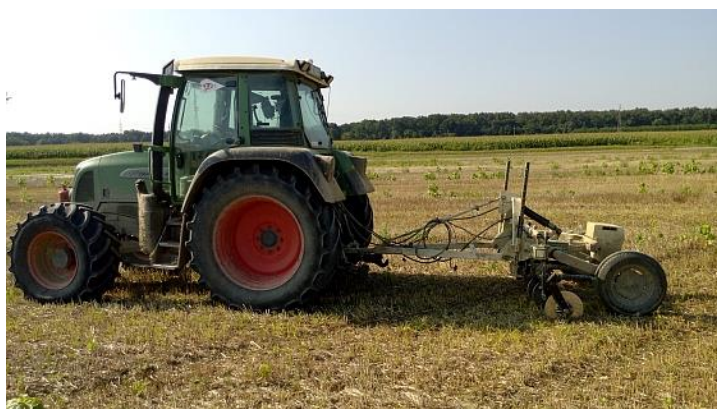
Slika 15. Skeniranje elektrovodljivosti tla
