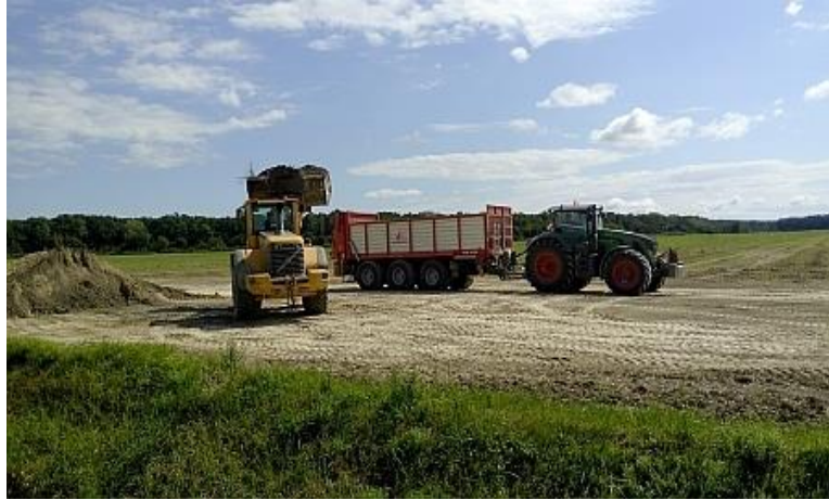
Slika 30. Raspodjela karbokalka prikolicom Annaburger vučenom teškim traktorom
