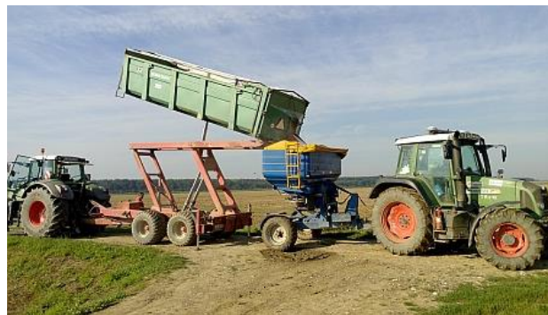
Slika 35. Punjenje rasipača Bogballe M3W pretovarnom prikolicom (vlastiti izvor)
