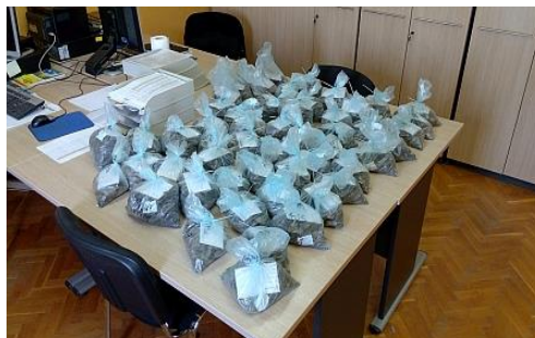
Slika 22. Priprema uzoraka tla za slanje u laboratorij na analizu (vlastiti izvor)
