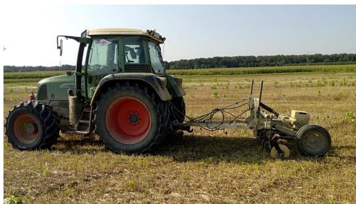
Slika 15. Skeniranje elektrovodljivosti tla
