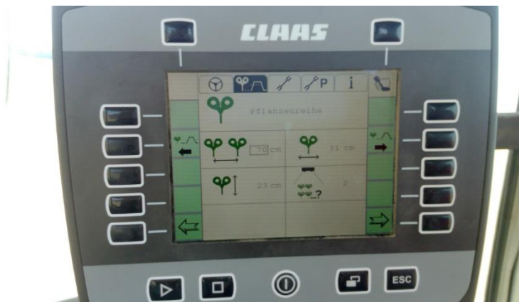
Slika 12. Podešavanje parametara kamere na monitoru
