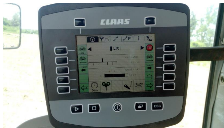
Slika 11. Monitor za nadzor kultivatora
