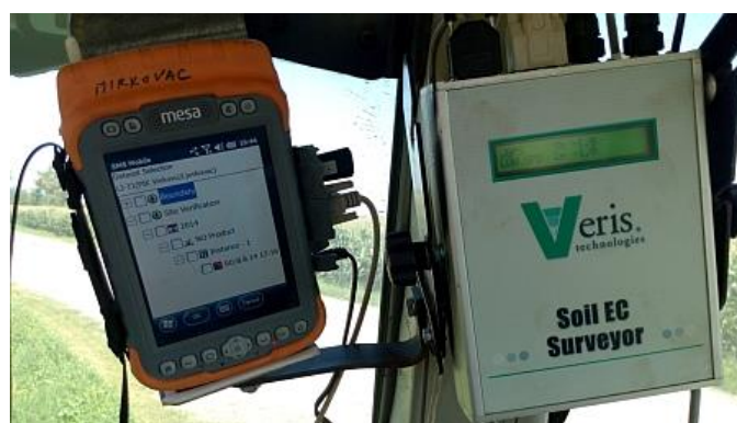
Slika 17. Oprema u traktoru potrebna za skeniranje elektrovodljivosti tla
