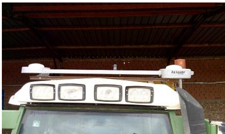
Slika 33. GPS antena montirana na krov traktora
