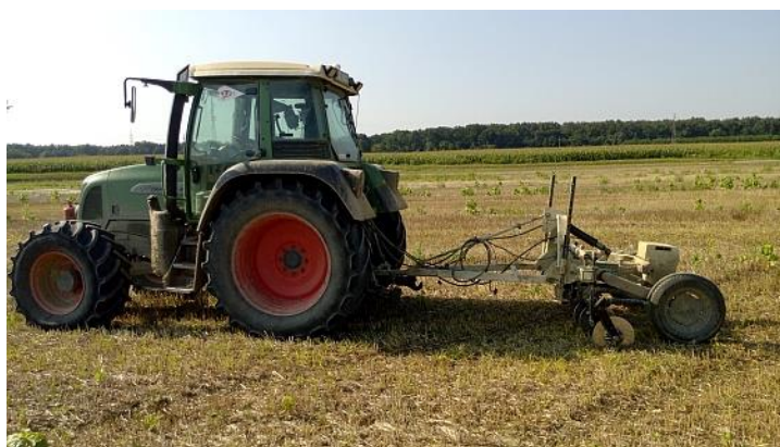
Slika 15. Skeniranje elektrovodljivosti tla
