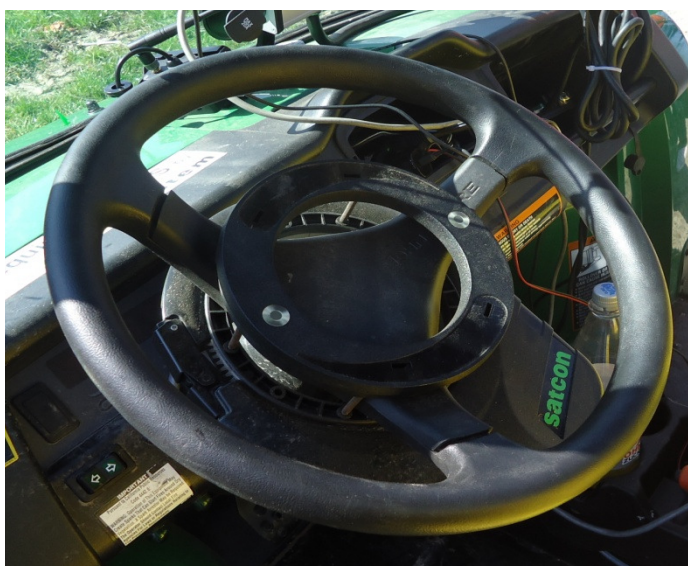
Slika 39. Sustav za automatsko upravljanje.
