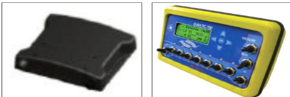
Slika 38. C- Box uređaj (lijevo) i uređaj za kontrolu sekcija B.MATIC 700 (desno).
