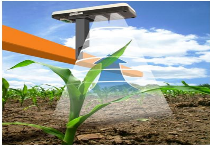
Slika 17. "OptRx" sustav za mjerenje refleksije biljke.
