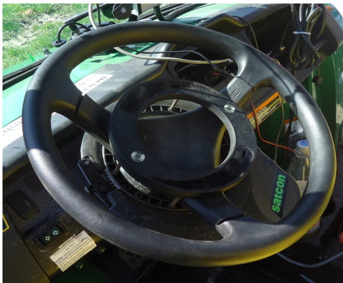
Slika 39. Sustav za automatsko upravljanje.
