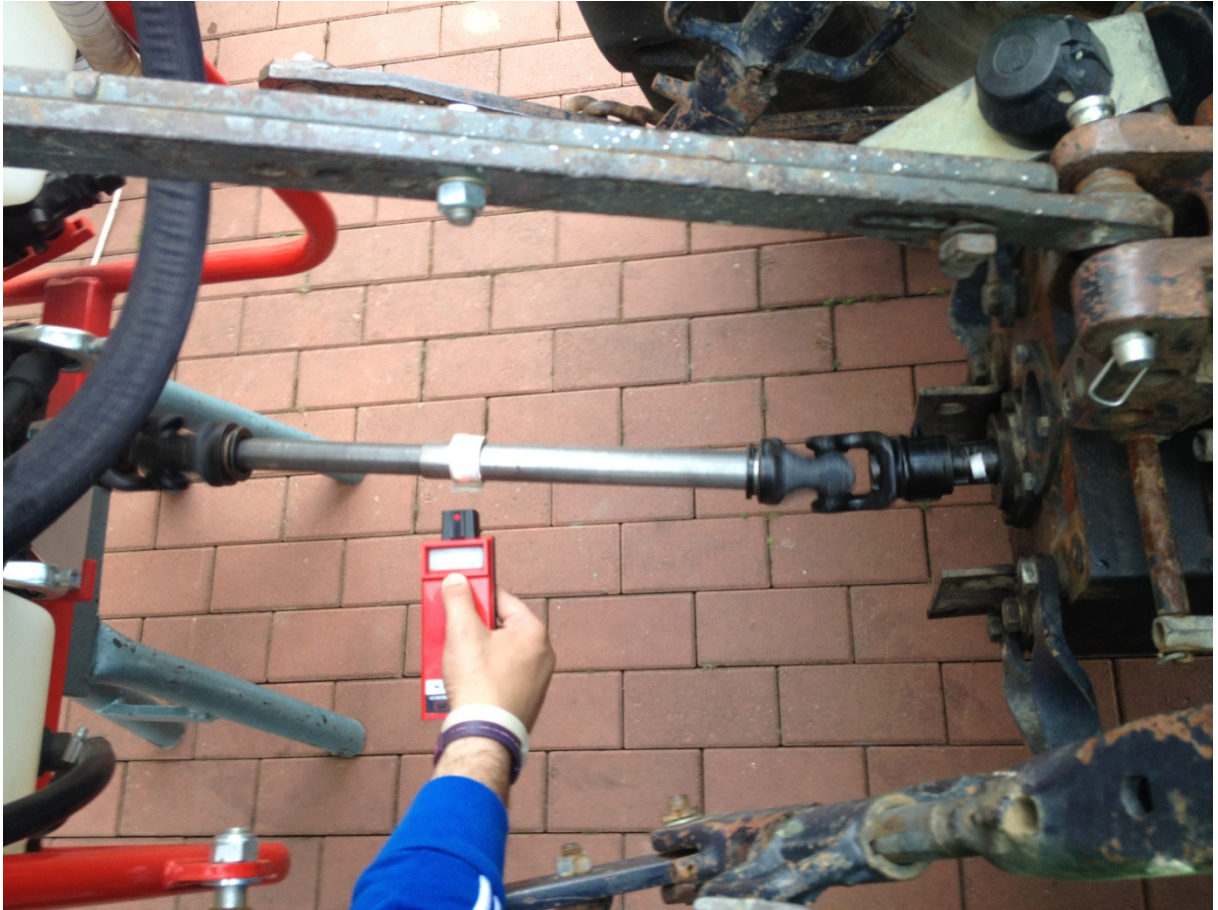
Slika 3. Tahometar Ornel HT 441
