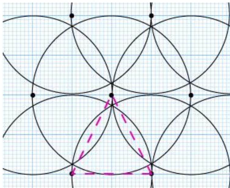
Slika 13. Preklapanje rasprskivača
