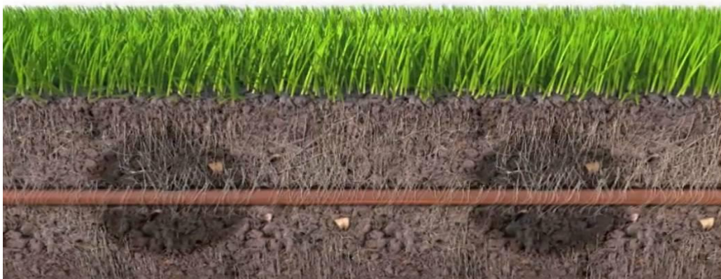
Slika 2. Podzemno navodnjavanje (Izvor: http://www.inaqua.hr )
