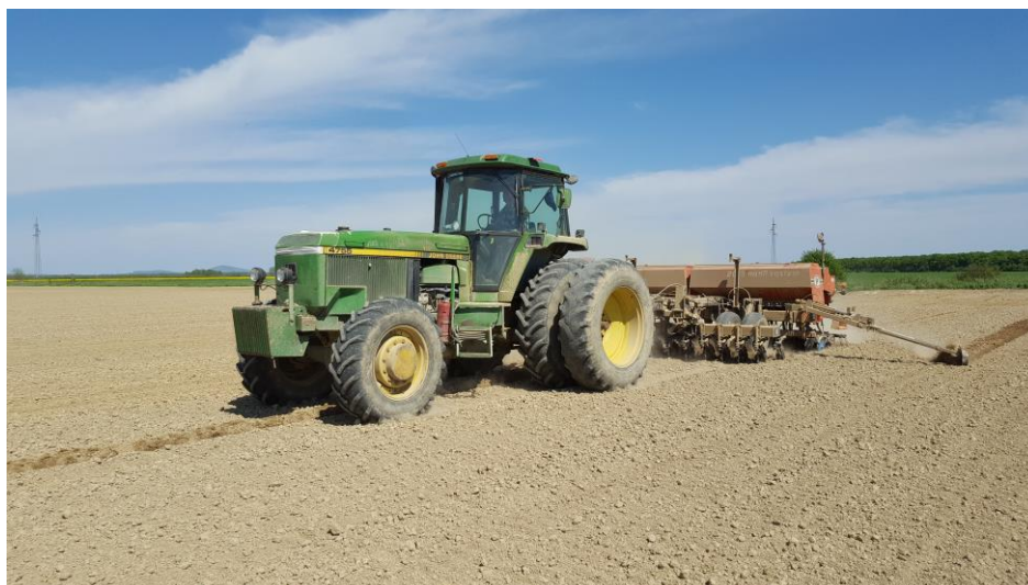
Slika 7. Sjetva s žitnom sijačicom ( Izvor: D. Dukmenić )
