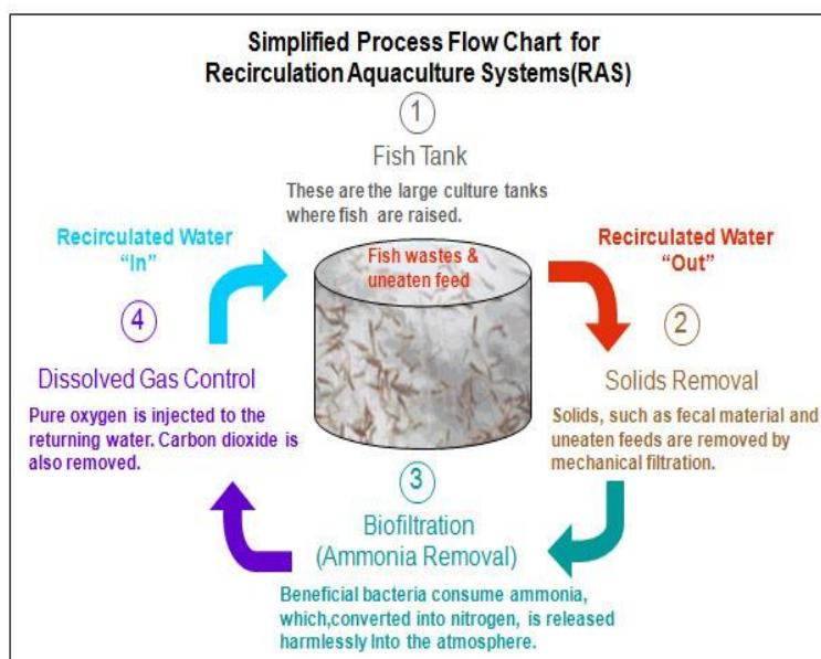
Slika 9 – Shema i pojednostavljeni procesi RAS-a
