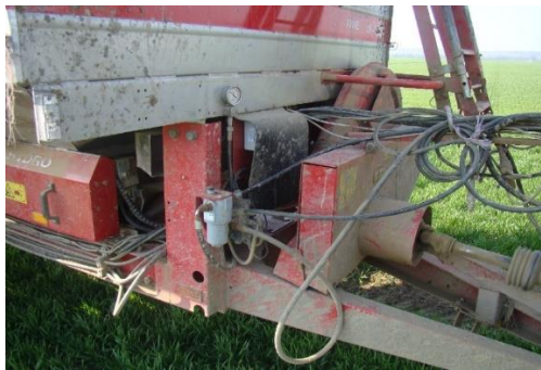
Slika 44. Manometar i električni skretni ventil na rasipaču Kongskilde Owerum Wing Jet (Izvor: P.Marić, 2015.)
