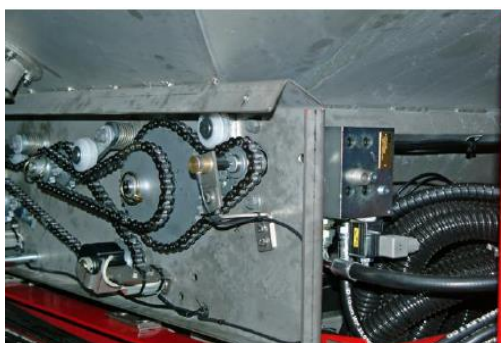
Slika 45. Sustav mjerenja za upravljanje preko hidrauličkog motora na rasipaču Kongskilde Owerum Wing Jet K-plus Hidro S 4024 (Izvor: http://www.kongskilde.com/sv/sv-SE/Agriculture/Soil/Fertilising%20technique// )
