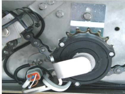
Slika 50. Električno punjeno kvačila i osovina sa djelomičnim isključenjem kontrolirana od upravljačke kutije u kabini traktora
