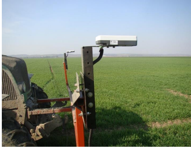
Slika 87. Pravilno postavljanje Ag Leader OptRx senzora (Izvor: P. Marić, 2015.)
