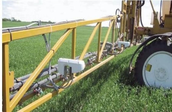
Slika 90. Greenseeker senzori postavljeni na grane prskalice
