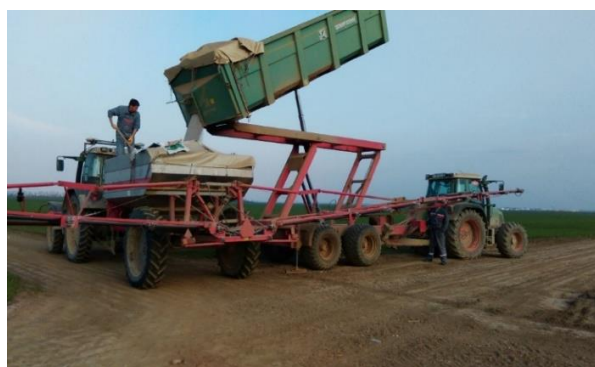
Slika 54. Punjenje rasipača Kongskilde Owerum Wing Jet K-plus Hidro S 4024 Belje d.d. (Izvor: P. Marić, 2015.)
