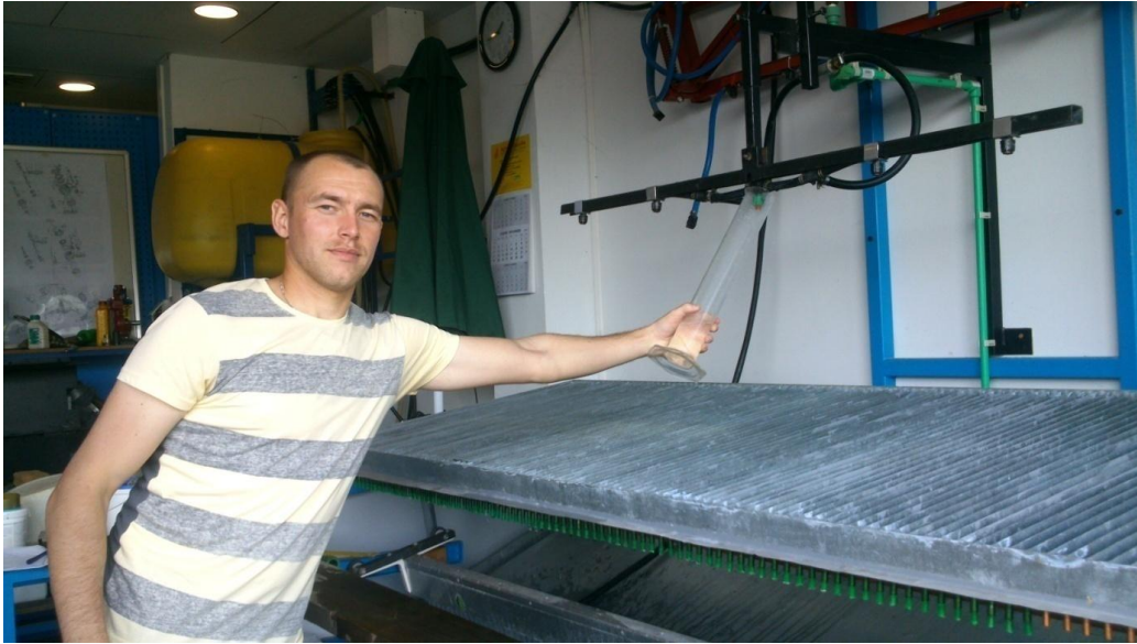
Slika 25. Ispitivanje protoka mlaznica
