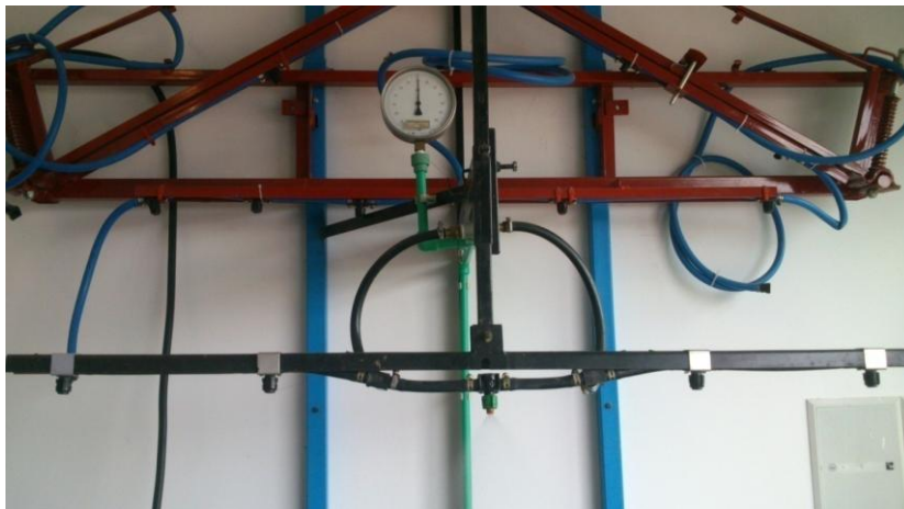
Slika 24. Podešeni tlak na ispitnoj stanici HR-004.
