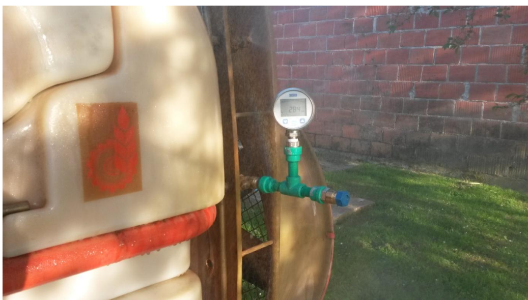
Slika 29. Prikaz tlaka nosača mlaznice
