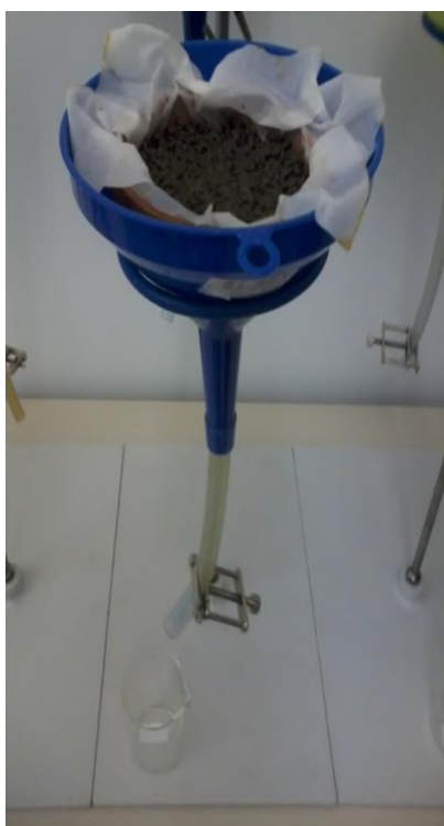
Slika 4. Baermannova metoda lijevka
