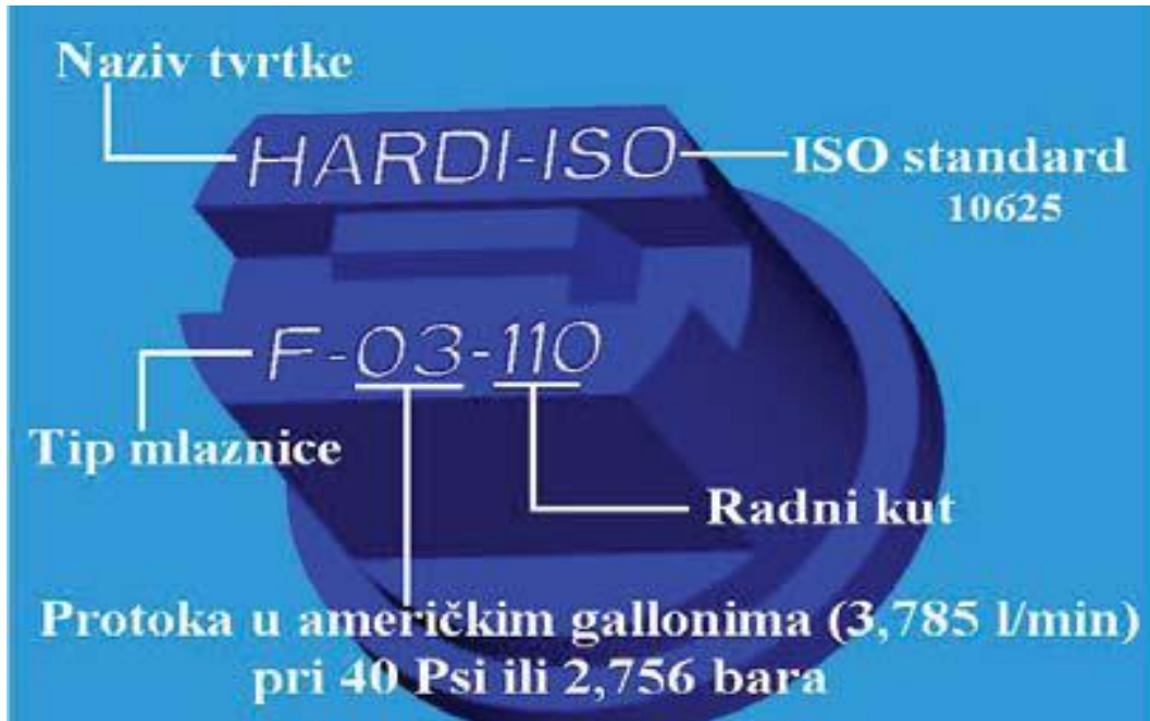
Slika 3. Način označavanja mlaznica prema ISO 10625 standardu
