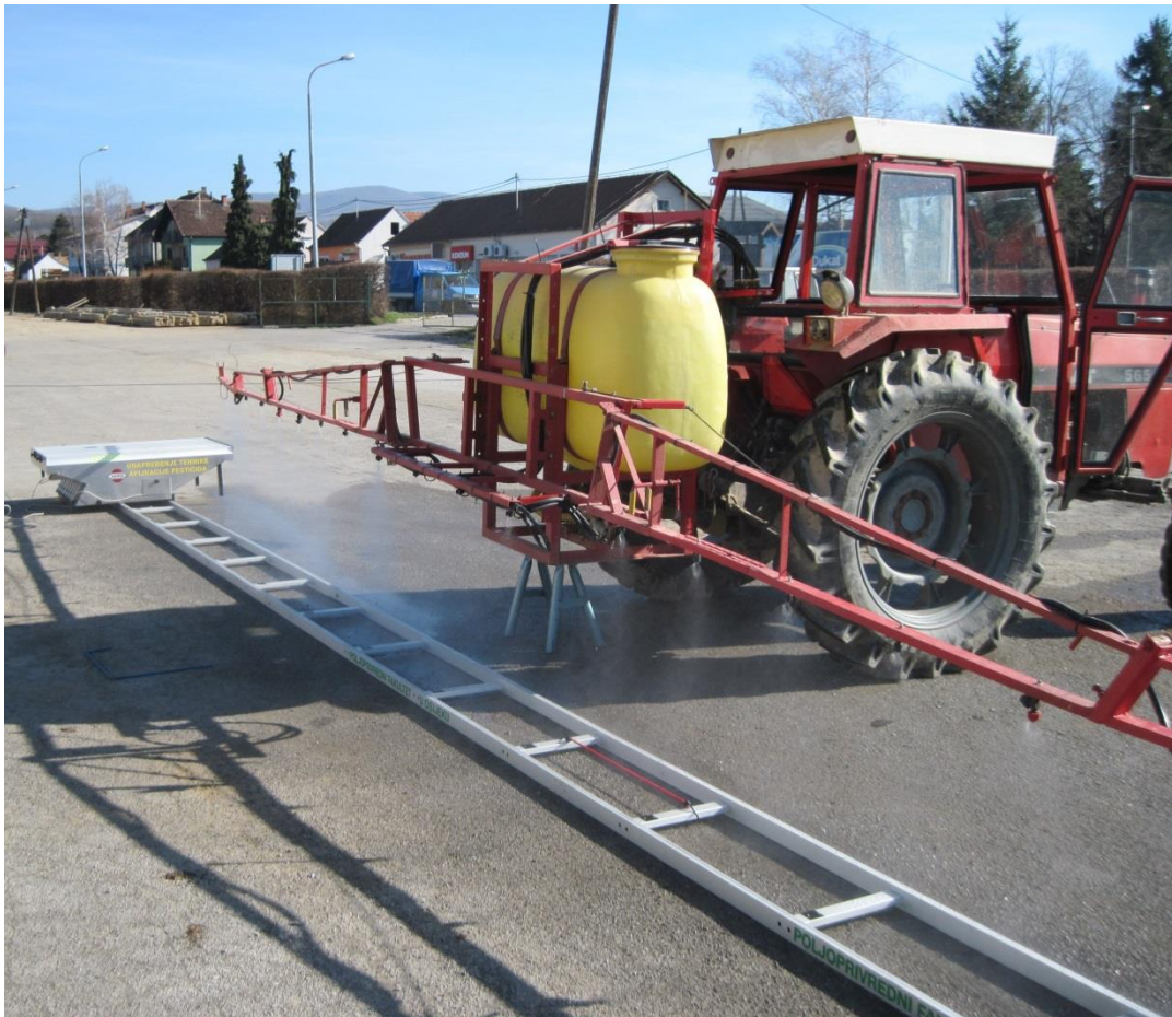
Slika 16. Poprečna raspodjela tekućine s uređajem spray scanner
