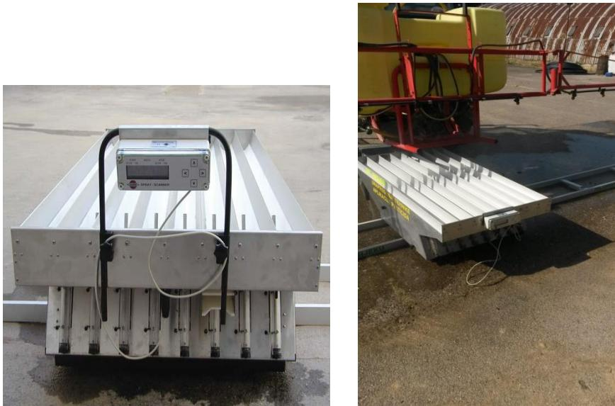
Slika 20. Uređaj za ispitivanje horizontalne raspodjele tekućine – *spray scanner*
