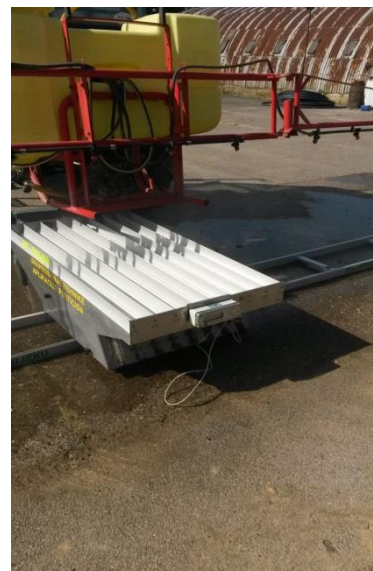
Slika 20. Uređaj za ispitivanje horizontalne raspodjele tekućine – spray scanner
