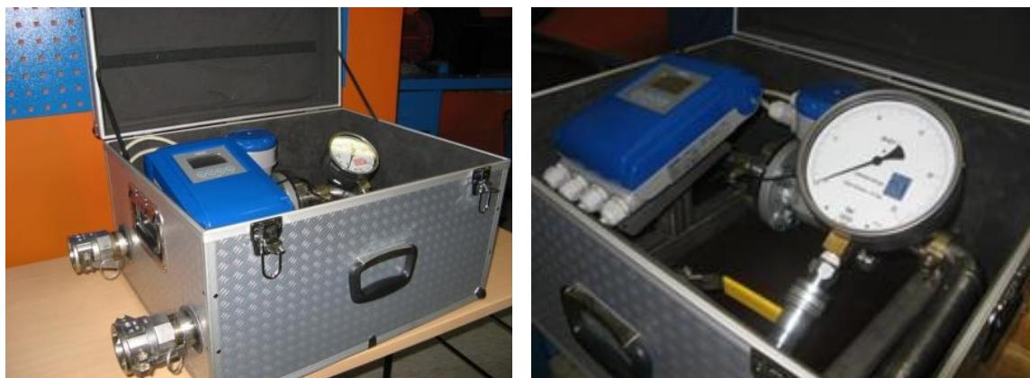
Slika 17. Elektromagnetni mjerač kapaciteta tvrtke *Krohne*
