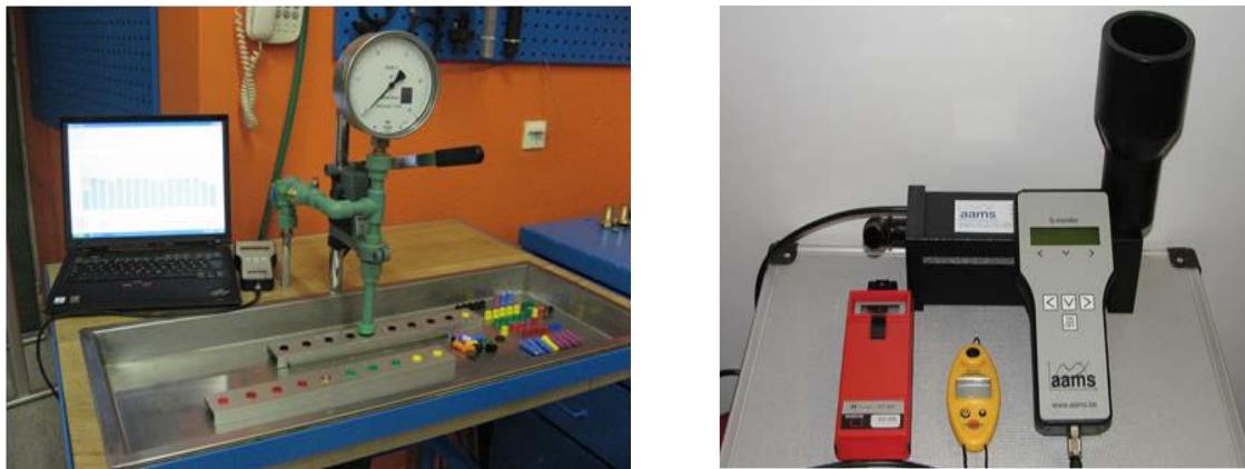
Slika 19. Stolno – elektronski uređaj za mjerjenje protoka mlaznica (lijevo) i uređaj za mjerjenje protoka AAMS (desno)
