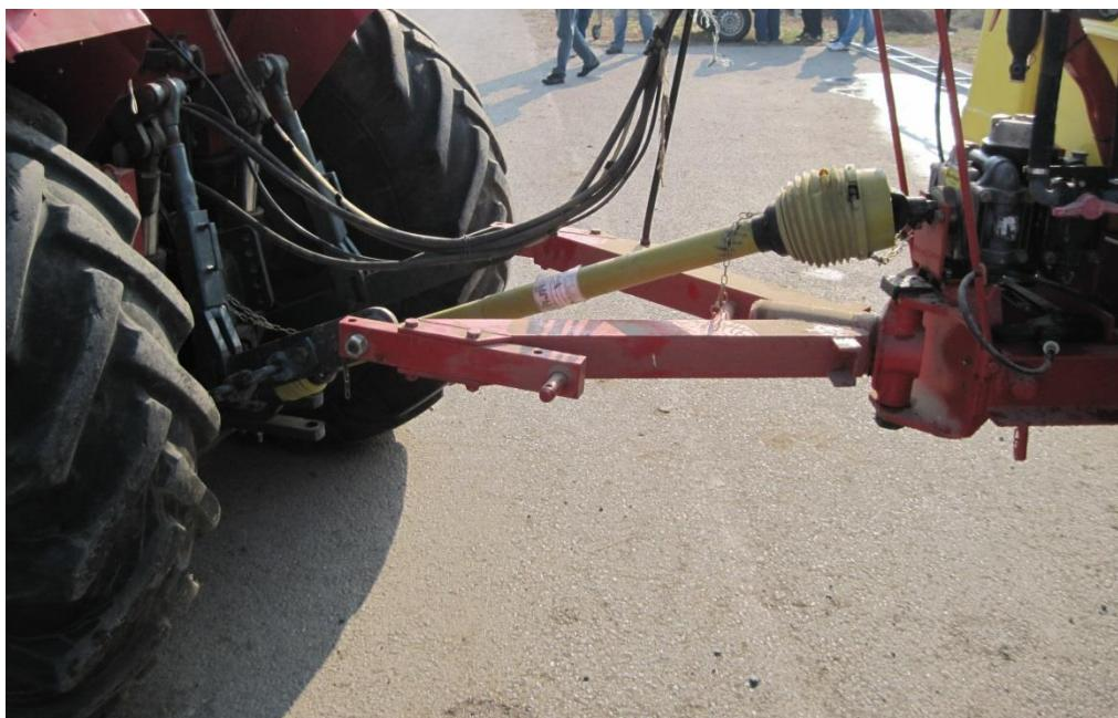
Slika 7. Propisano zaštićeno kardansko vratilo
