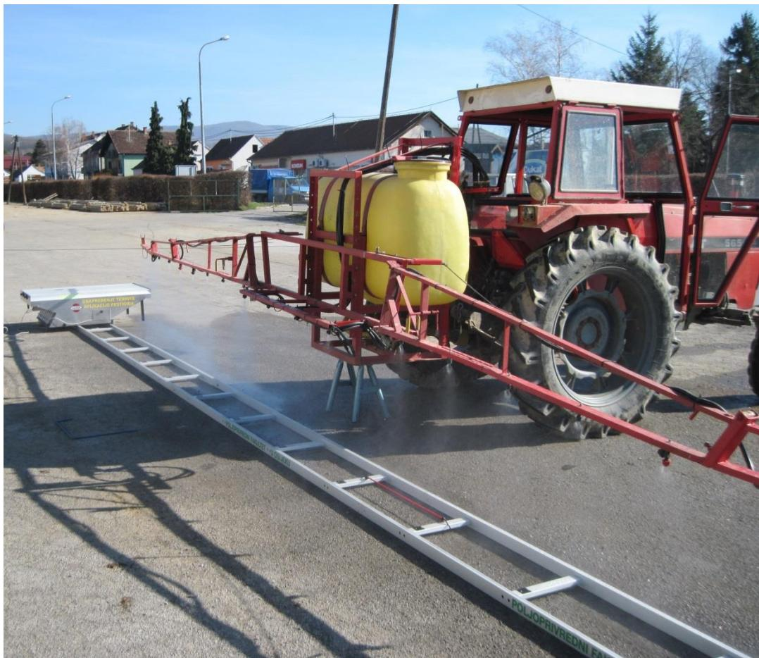
Slika 16. Poprečna raspodjela tekućine s uređajem *spray scanner*
