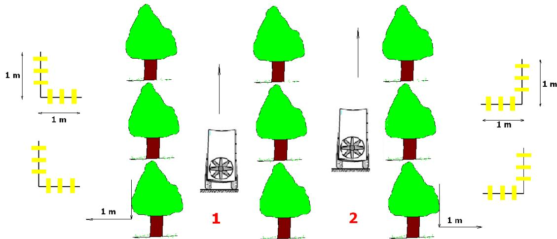
Slika 9. Shema postavljanja vodoosjetljivih papirića za mjerjenje zanošenja
