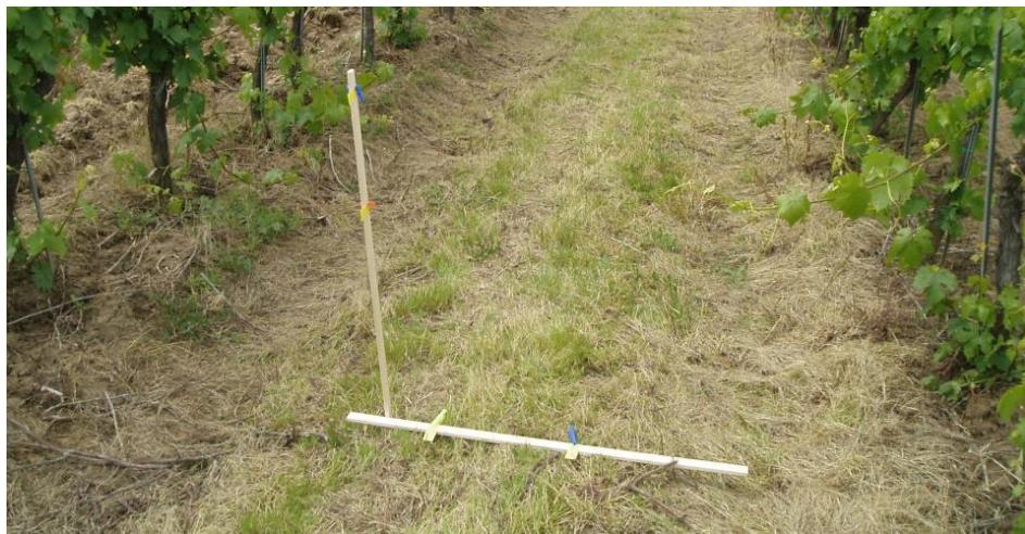
Slika 10. Mjerjenje zanošenja pomoću VOP-a
