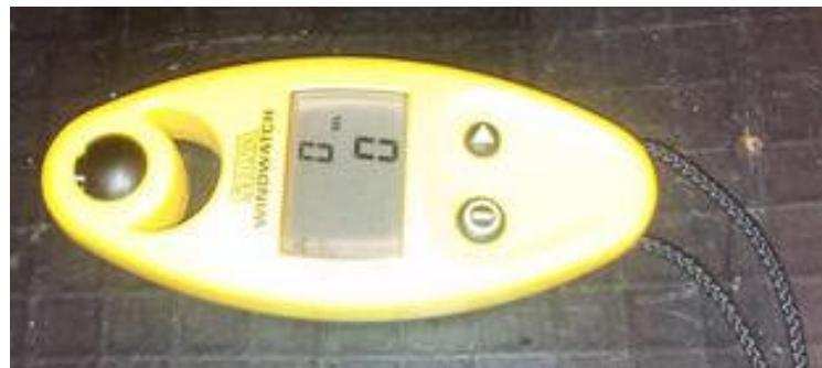
Slika 5. Anemometar *Silva Windwatch*
