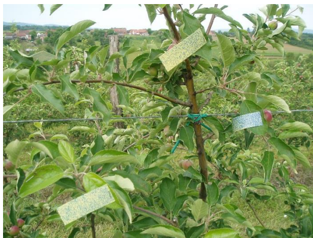
Slika 2. Vodoosjetljivi papirići (VOP) na jabuci (izvor: Tadić, V.)
