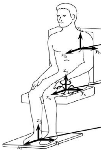
Slika 1. Tri osnovne osi djelovanja vibracija na tijelo čovjeka (Fundamentals of sound and vibration, 2015.)
