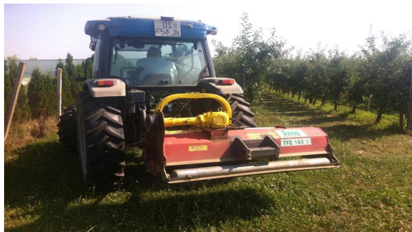
Slika 5. Traktor agregatiran s malčerom (vlastita fotografija)
