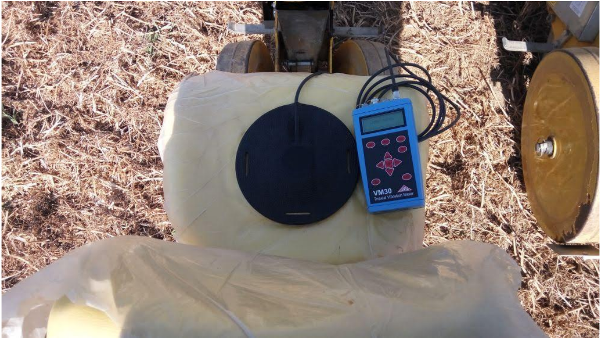
Slika 10. Uređaj za mjerenja vibracija (vlastita fotografija)
