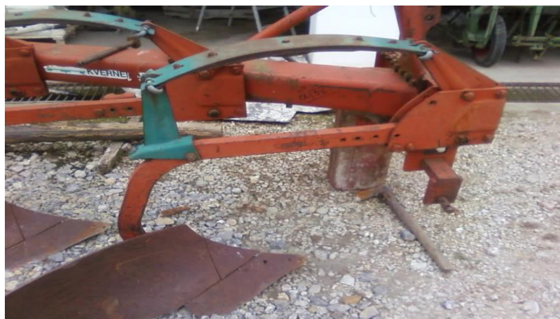
Slika 9. Trobrazdni plug (Izvor: K. Šafran)
