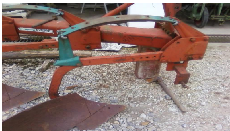
Slika 9. Trobrazdni plug (Izvor: K. Šafran)
