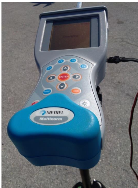
Slika 3. Uređaj s kojim se obavljalo mjerenje (Metrel Multinorm MI 6201 EU) (vlastita fotografija)
