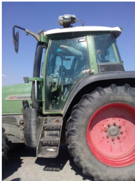
Slika 6. Mjerenje buke u kabini traktora i postavljanje uređaja (vlastita fotografija)
