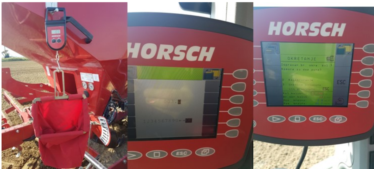
Slika 20. Kalibracija sjemena - 1. Vaganje sjemena, 2. Unos vrijednosti utroška kg/ha, 3. Kalibracija (Izvor: vlastita fotografija)
