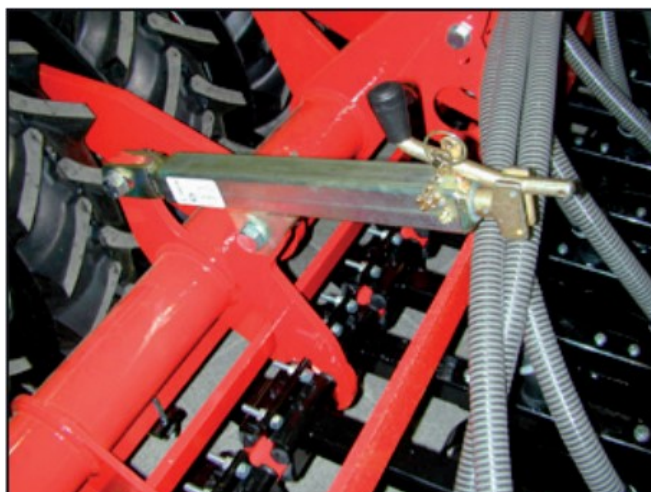
Slika 22. Ručica za podešavanje pritiska ulagača (Izvor: Uputa za rad, Art.: 80441702 hr)
