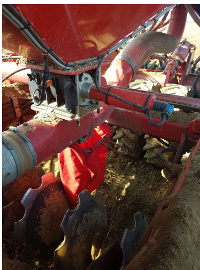
Slika 19. Ispuštanje sjemena u vreću (Izvor: vlastita fotografija)
