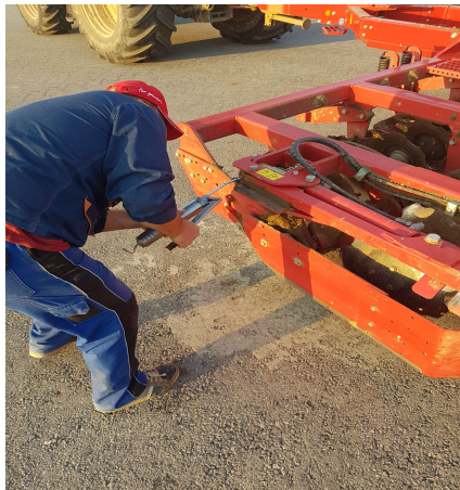
Slika 4. Podmazivanje radnog stroja mazalicom (Izvor: vlastita fotografija)
