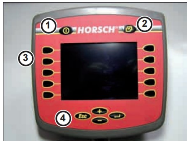
Slika 25. Zaslona računala „DrillManager ME“-a - 1. Tipka "uključeno/isključeno", 2. Prebacivanje upravljanja sustava na program sjetve ili servis, 3. Tipkovnica i ekran, 4. Tipke za biranje, podešavanje i promjenu brojevnih vrijednosti i funkcija (Izvor: Uputa za rad, Art.: 80661703 hr)
