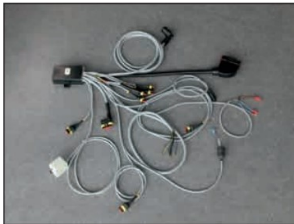
Slika 26. Kabelski snop (Izvor: Uputa za rad, Art.: 80661703 hr)
