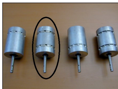
Slika 16. Rotor za sitno sjeme - označeni rotor se koristi u sijačici „Horsch“ na OPG-u „Jelošek Zlatko“ (Izvor: Uputa za rad, Art.: 80441702 hr)
