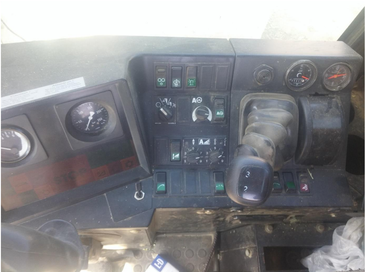
Slika 19. Radna ploča i mijenjač brzina (3 stupnja), (Izvor : Kolak, I.)
