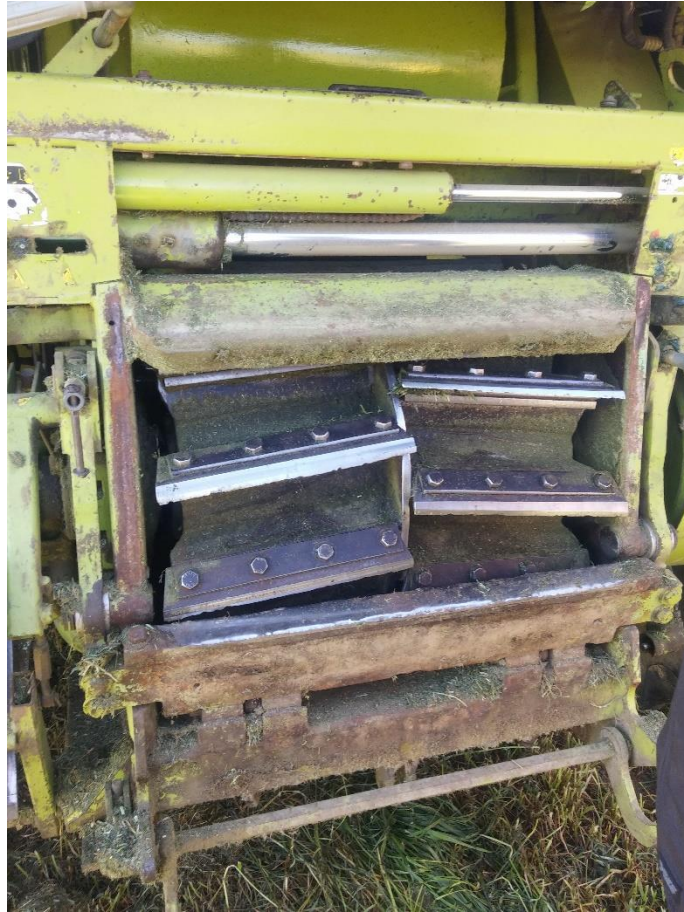
Slika 13. Položaj noževa i kontranoža na bubnju silažnog kombajna. (Izvor : Kolak, I.)
