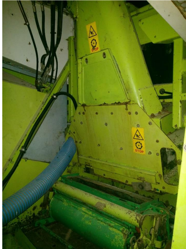
Slika 16. „Vjetar“ sa „corn-crackerom“ (Izvor : Kolak, i:)
