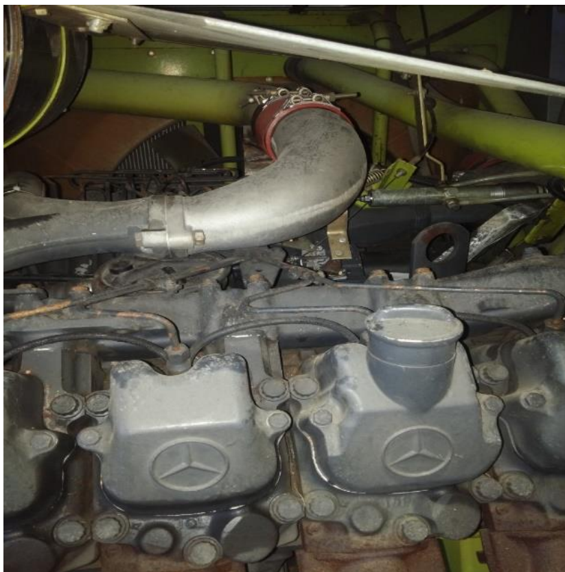
Slika 8. MercedesBenzov motor snage 268 kW (Izvor : Kolak, I.)
