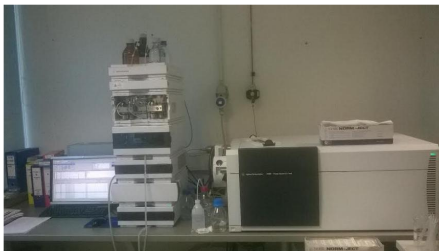
Slika 12. Uređaj MS/MS HPLC - određivanje mikotoksina (uređaj visoke točnosti).
