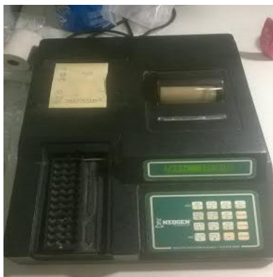
Slika 11. Uređaj ELISA - određivanje mikotoksina (orijentacioni test).
