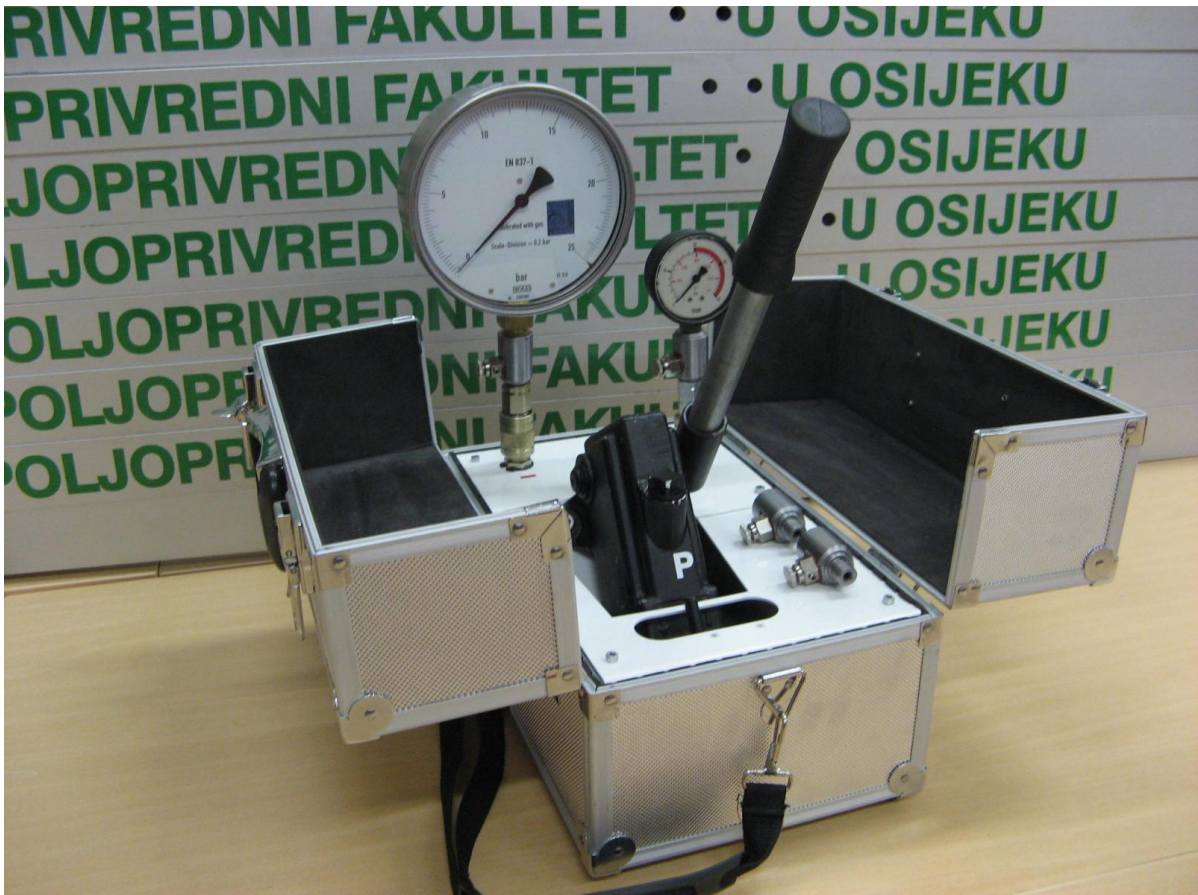
Slika 5. Ispitivanje ispravnosti rada manometra
