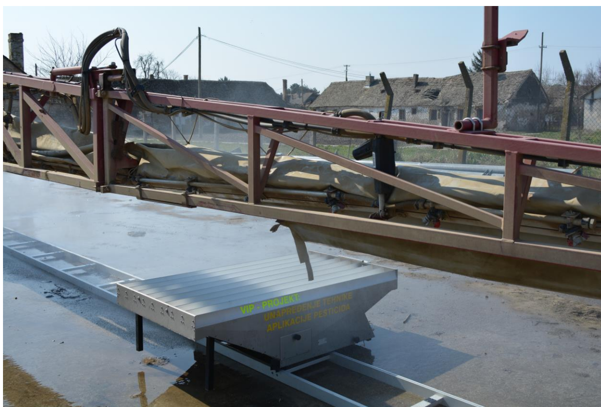
Slika 7. Mjerenje raspodjele tekućine pomoću uređaja Hardi Spray Scanner
