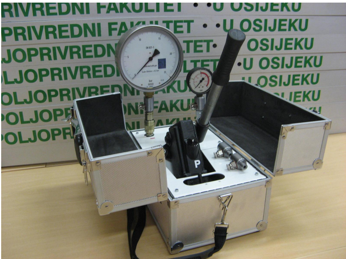
Slika 5. Ispitivanje ispravnosti rada manometra
