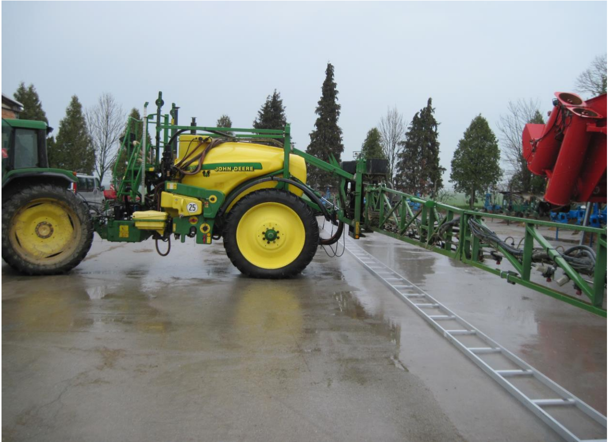
Slika 15. Testiranje površinske raspodjele tekućine na prskalici John Deere 3173
