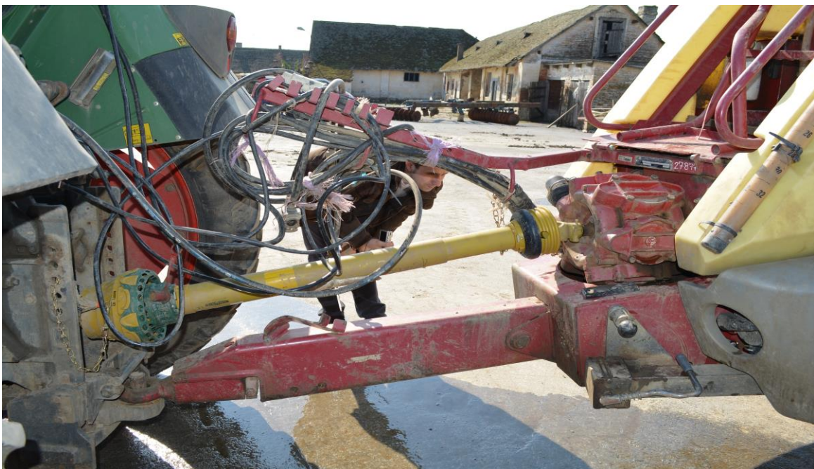
Slika 1. Pravilna zaštita PVT – a na prskalici Hardi Commander
