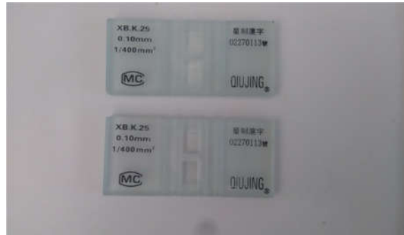
Slika 18: Dva hemocitometra korištena u ovom istraživanju
