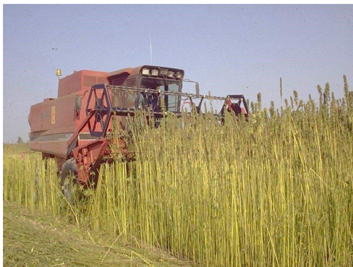
Slika 6: Žetva konoplje za sjeme aksijalnim kombajnom
